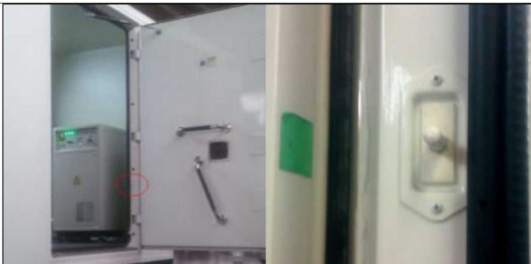
FS6000 (BX) 集装箱/集卡快速检查系统的电子加速器舱门（右图为左图红圈内物体的放大图像）
