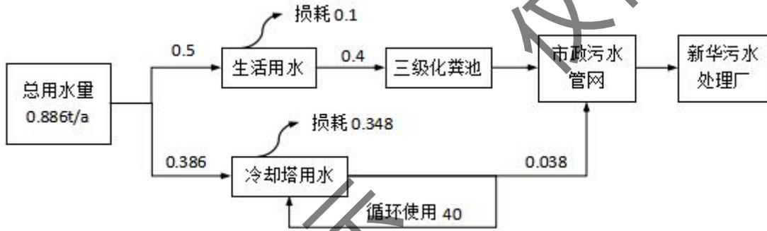
图 2-1 项目日水平衡图 (t/d)
