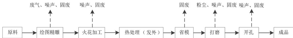
图 5-1 模具生产工艺流程图
