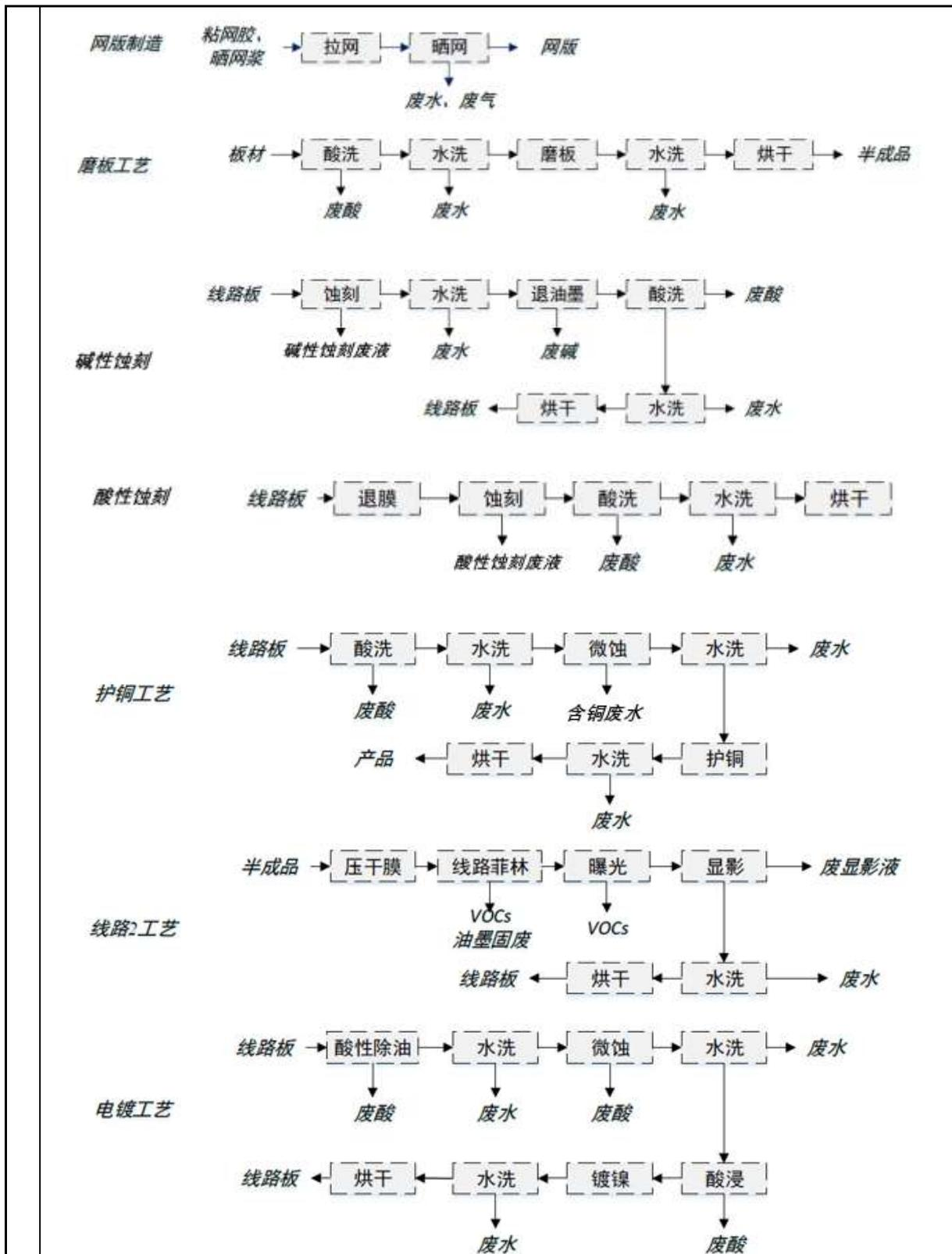
图 2-7 现有项目单面板各重点工艺流程细化图
