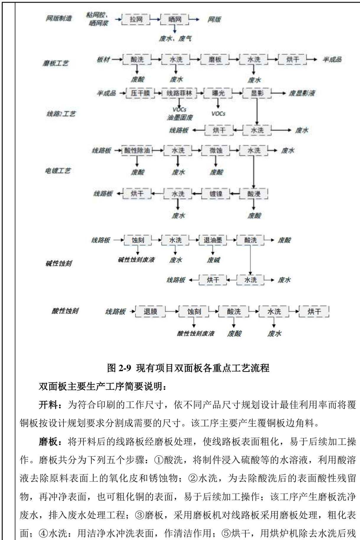
图 2-9 现有项目双面板各重点工艺流程
