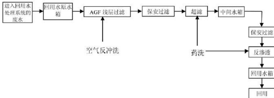
图 4-4 回用水工艺流程图
