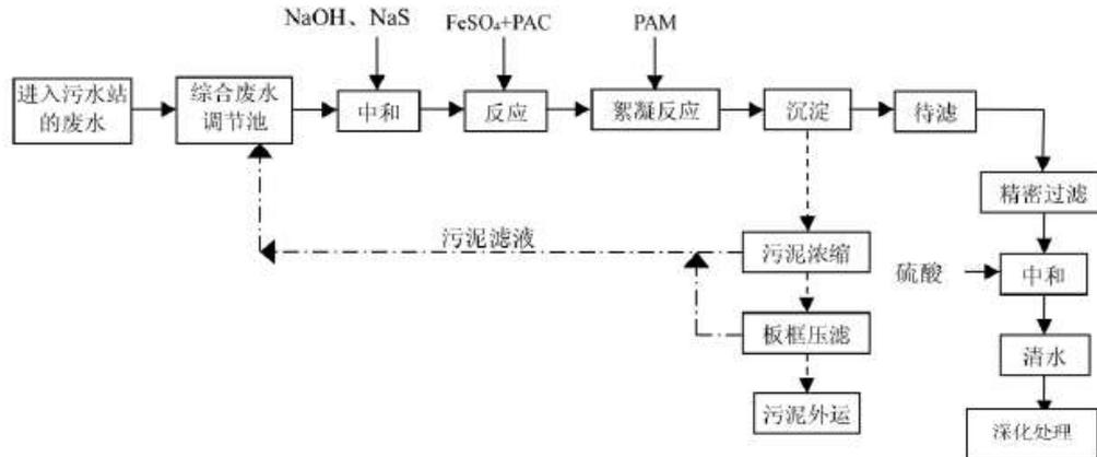
图 2-13 污水处理站废水处理工艺流程图
