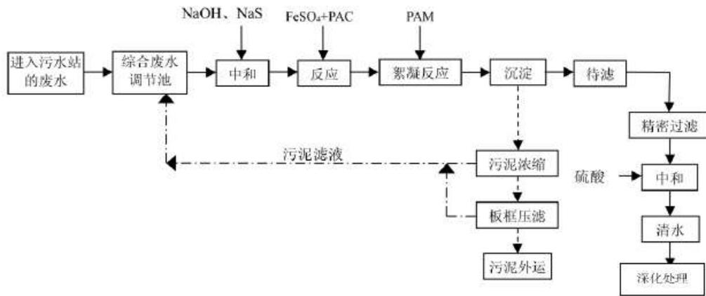
图 4-2 污水处理站废水处理工艺流程图
