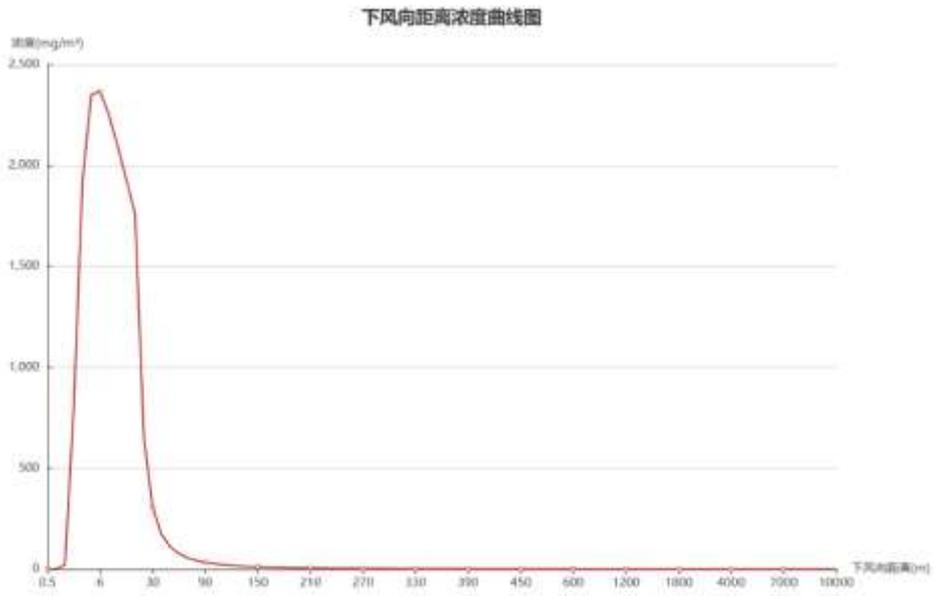
图 7.1-1 氨气扩散下风向最大浓度曲线图
