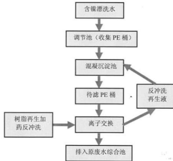
图 2-11 现有项目含镍废水处理工艺流程
