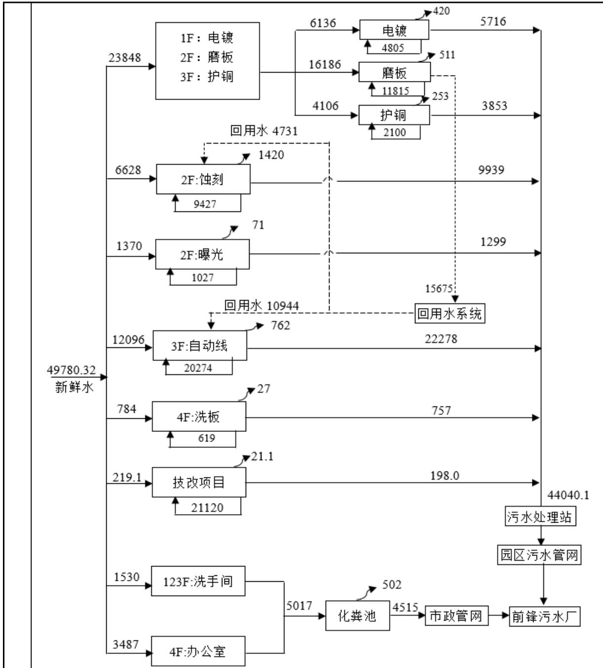
图 2-2 技改后全厂水平衡图（单位：m³/a）
