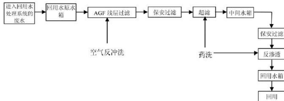
图 2-15 回用水工艺流程图
