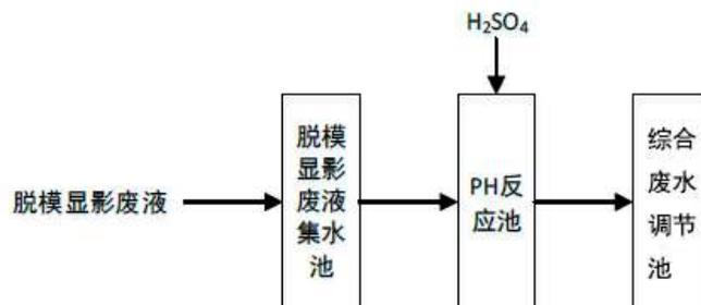
图 2-12 油墨及脱膜显影废液预处理工艺流程图
