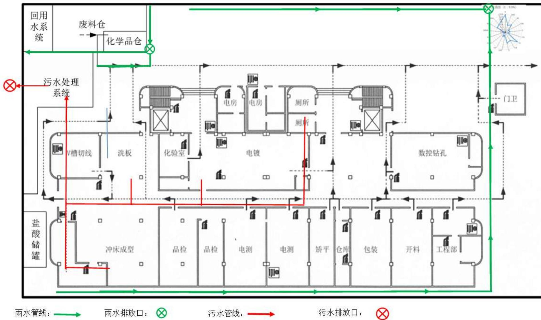
附图 17 碱性蚀刻液再生车间平面布局图
