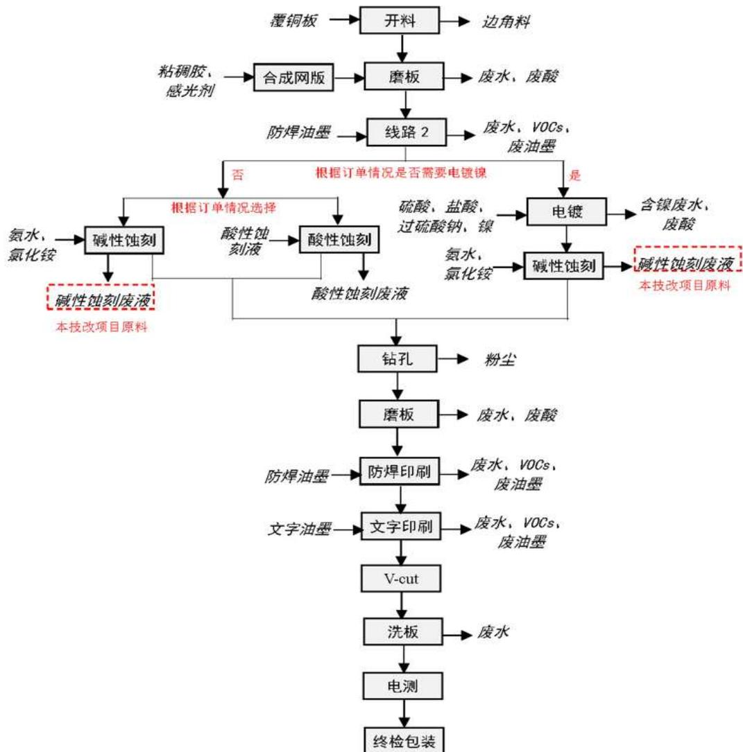
图 2-8 现有项目双面板生产工艺流程
