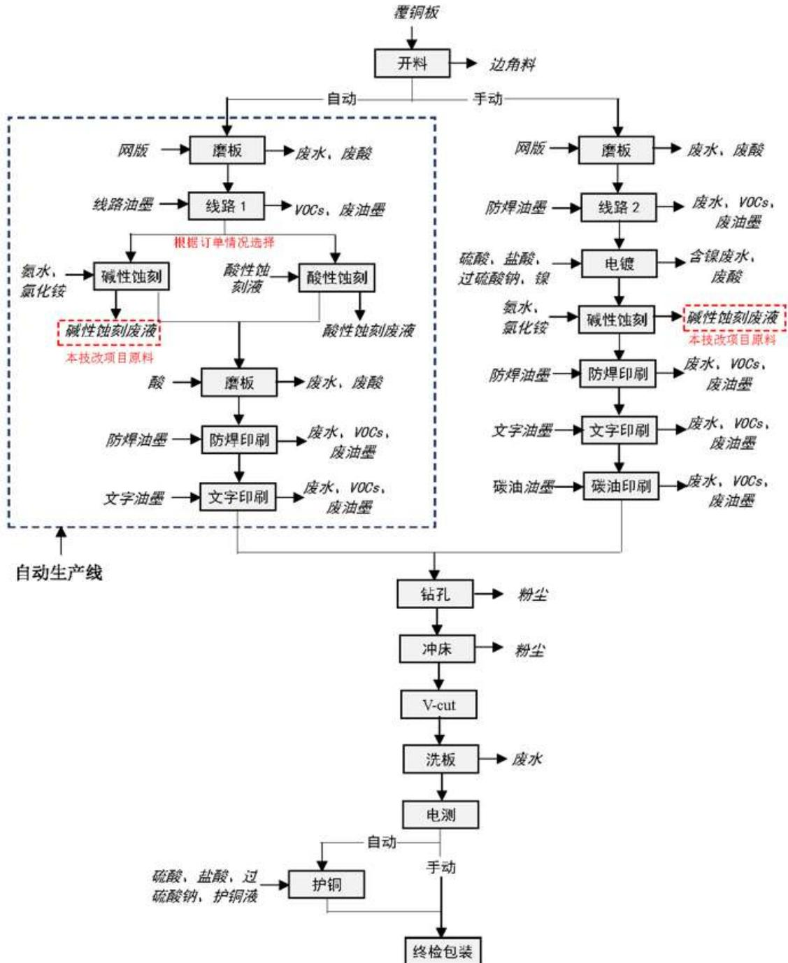
图 2-6 现有项目单面板生产工艺流程
