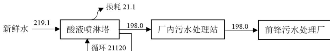
图 2-1 本项目水平衡图 (单位: m<sup>3</sup>/a)
