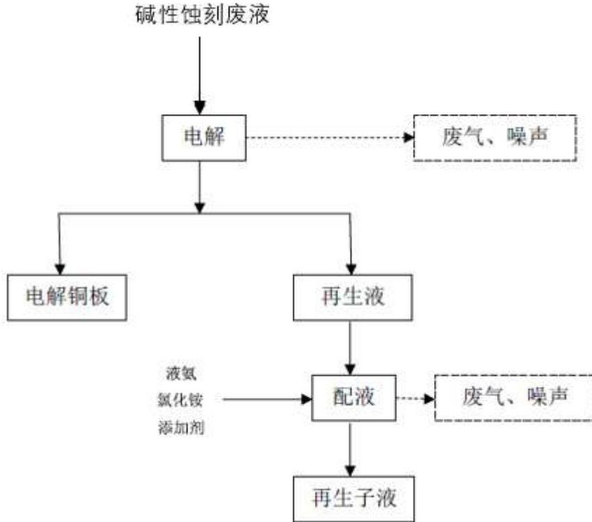
图 2-5 技改项目工艺流程图
