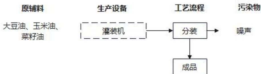
图 2-4 大豆油、玉米油、菜籽油生产工艺流程图
