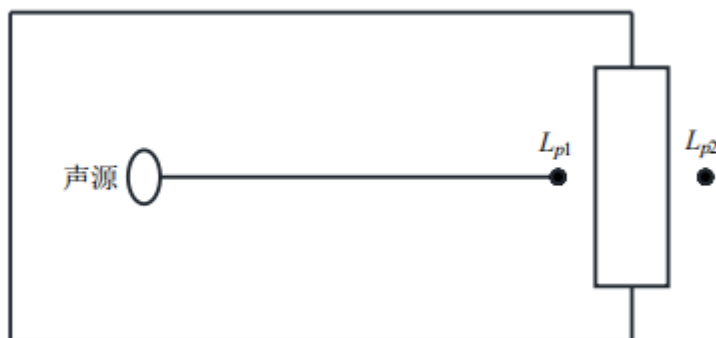
图 4-1 室内声源等效为室外声源图例
