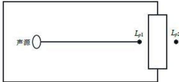
图 4-3 室内声源等效为室外声源图例
