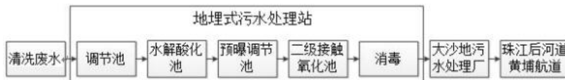
图 4-4 厂区污水处理站处理工艺流程
