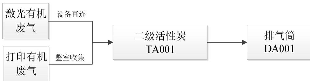
图 4-2 本项目废气处理工艺流程示意图
