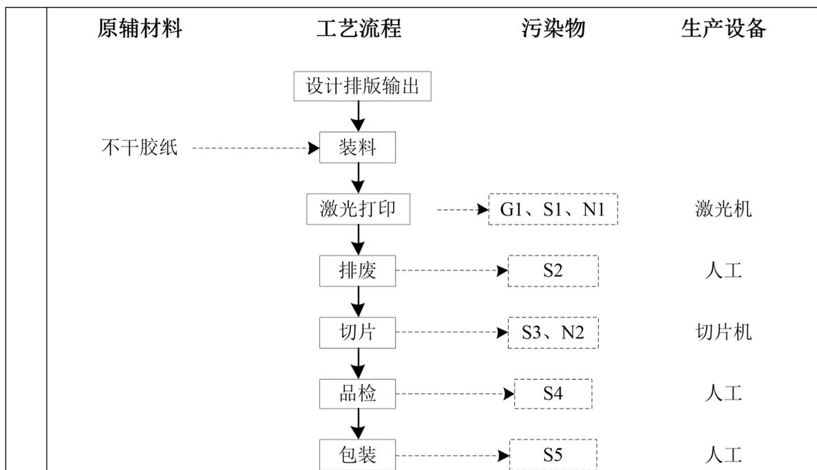
图 2-5 纹身贴激光生产工艺流程图
