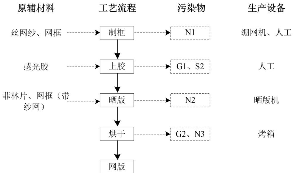
图 2-3 制版工艺流程图
