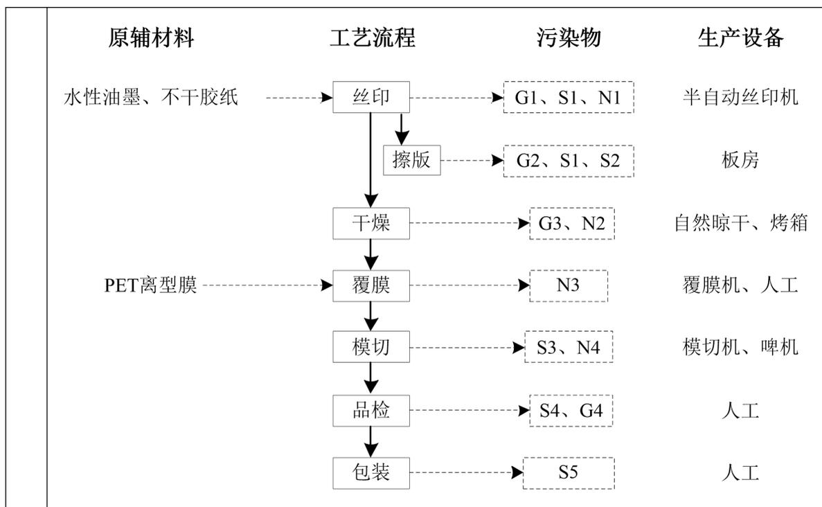
2-6 标签贴纸生产工艺流程图
