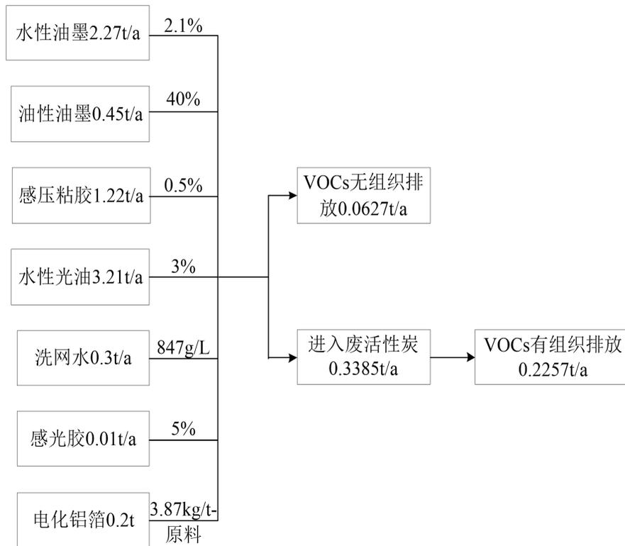
图 2-1 本项目挥发性有机物平衡图
