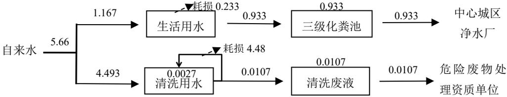
图 2-1 项目水量平衡图 单位: t/d
