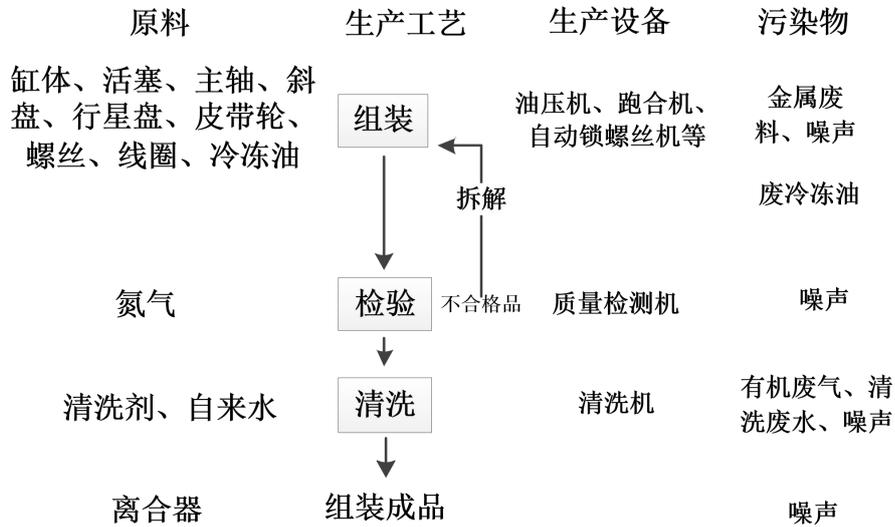
图 2-3 项目压缩机生产工艺流程图
