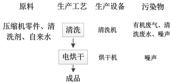
图 2-2 项目清洗零件工艺流程图
