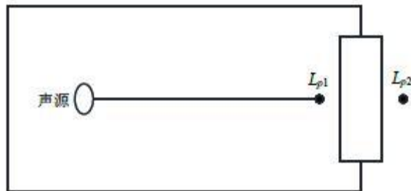
图 4-1 室内声源等效为室外声源图例
