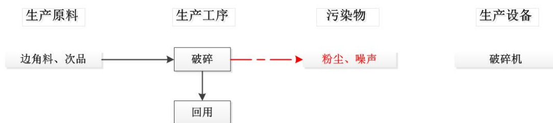
图 2-4 本项目破碎工艺流程及产污环节图
