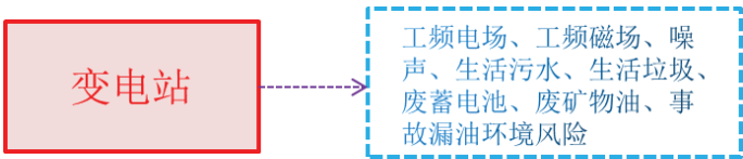
图 3-3 本工程运行期产污节点图
