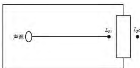
图 4-1 室内声源等效为室外声源图例
