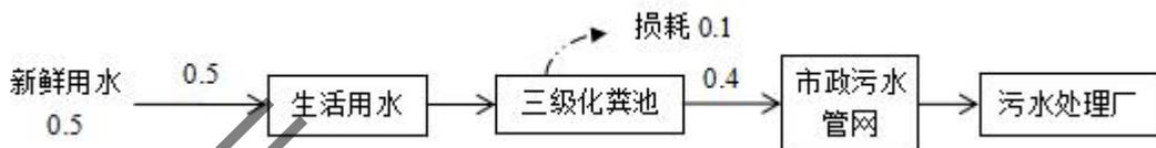
图 2-1 本项目日水平衡图 (t/d)
