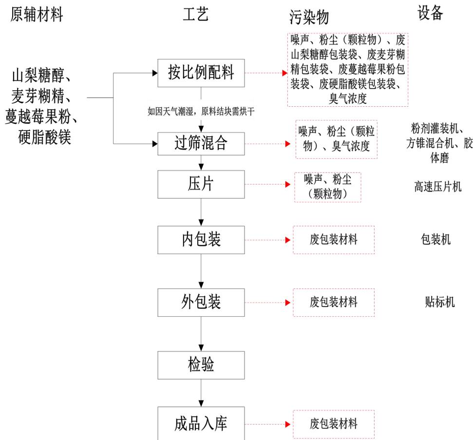
图 2-2 压片糖果生产工艺流程图
