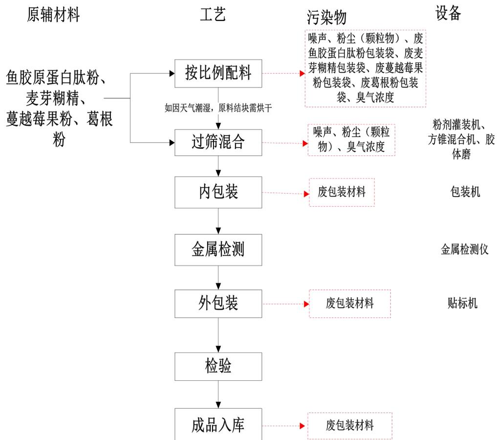
**图 2-3 固体饮料生产工艺流程图**
