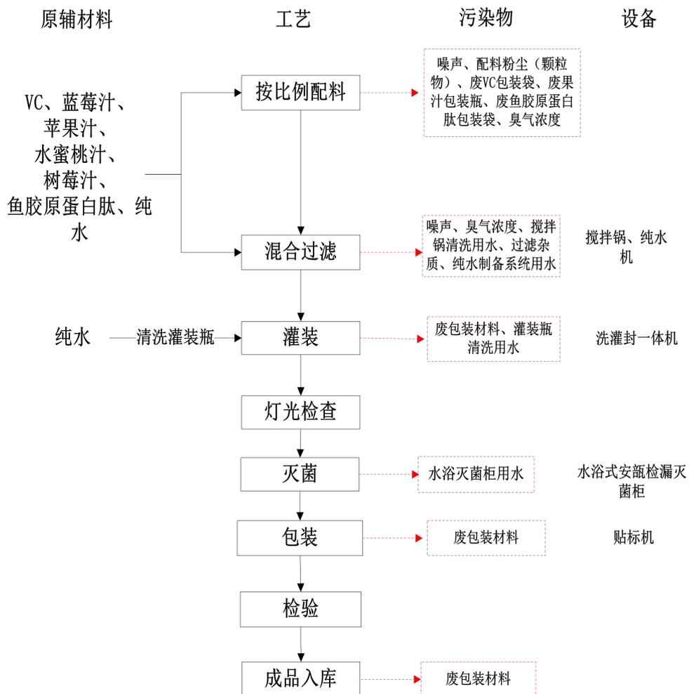
图 2-4 液体饮料生产工艺流程图
