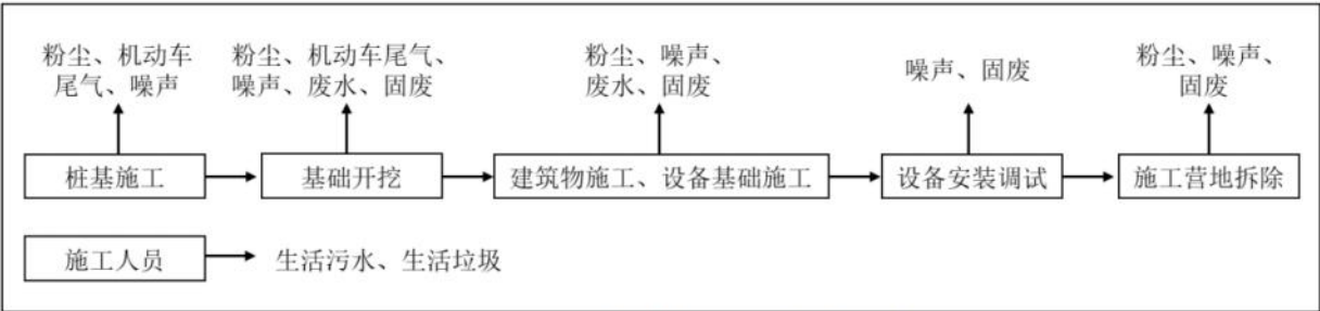
图 3.2-1 施工期工艺流程及产污节点图
