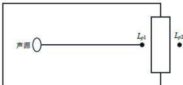
图 4-1 室内声源等效为室外声源图例
