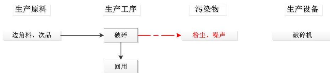
图 2-4 本项目破碎工艺流程及产污环节图
