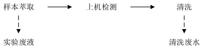
图 2-5 串联质谱检测服务实验流程及产污环节图
