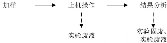
图 2-4 常规生化项目检测服务实验流程及产污环节图
