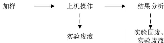
图 2-3 化学发光检测服务实验流程及产污环节图
