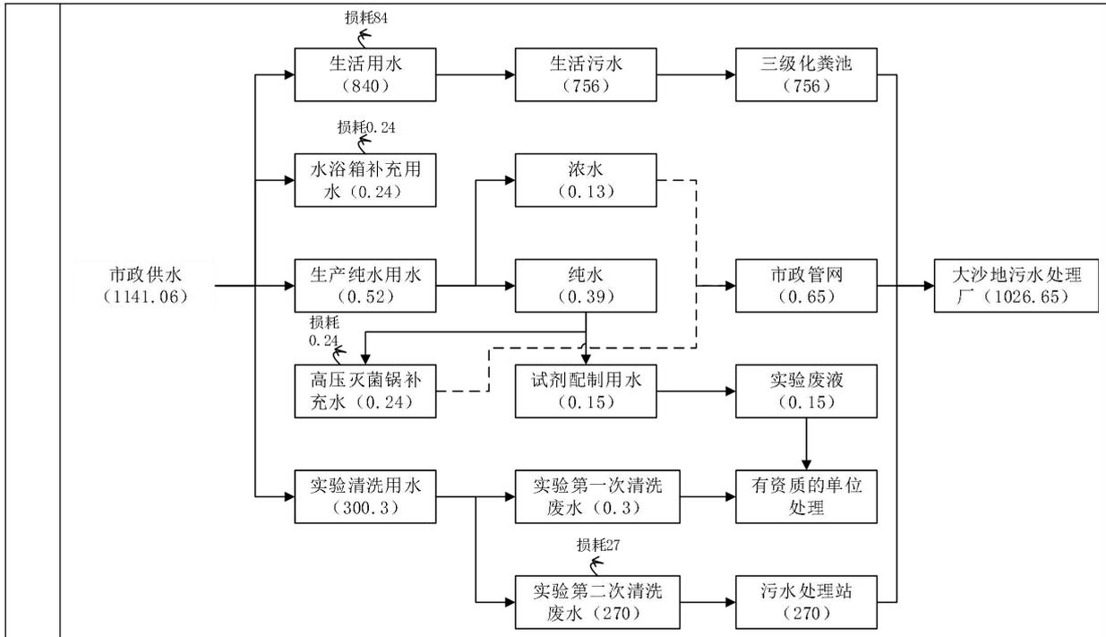
图 2-1 迁扩建项目水平衡图 (单位 t/a)
