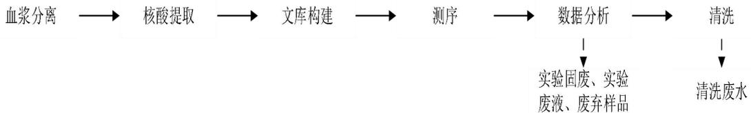
图 2-2 基因检测服务实验流程及产污环节示意图
