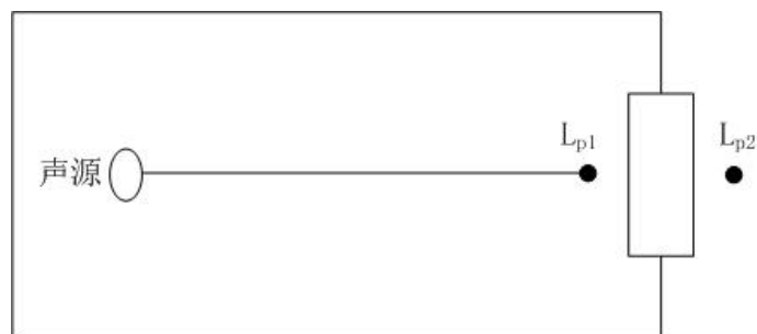
图 10 室内声源等效为室外声源图例
