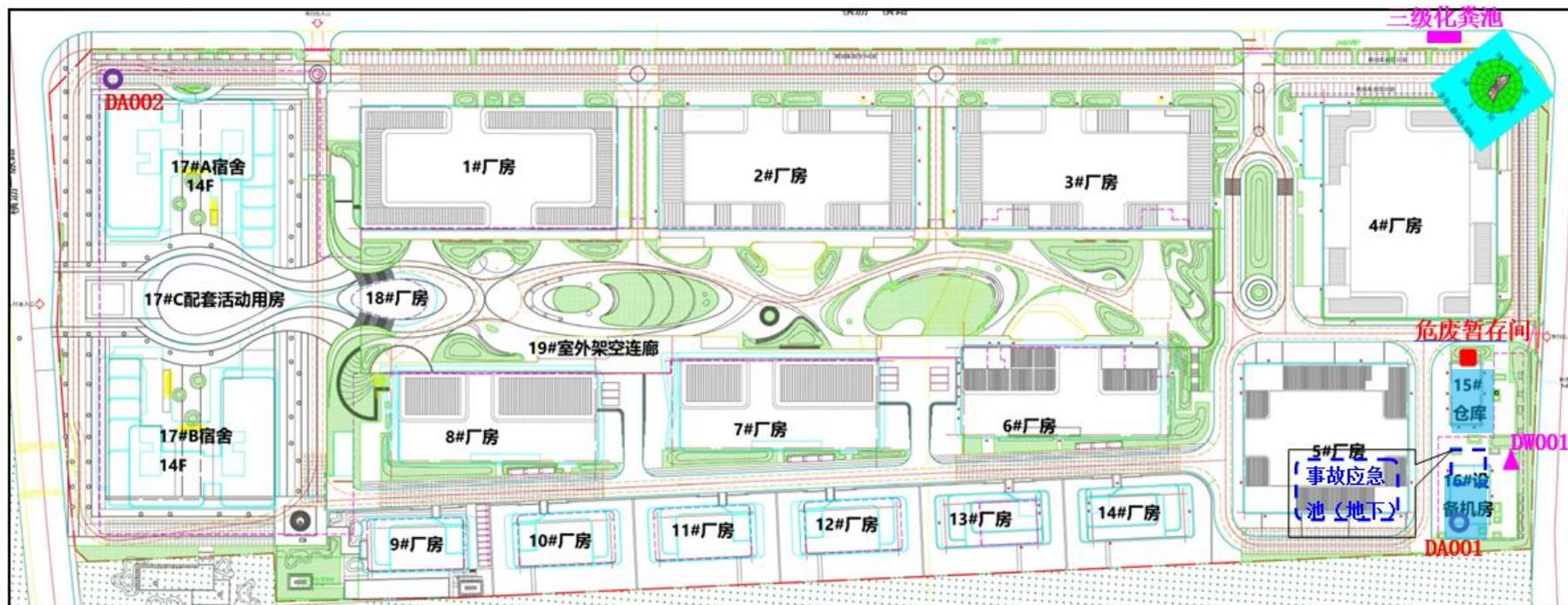
图例: ○DA001 臭气排气筒, DA002 油烟排气筒 ▲ 自建污水站污水排放口 ■ 三级化粪池 ■ 危废暂存间 □ 应急事故池 ■ 危险单元
