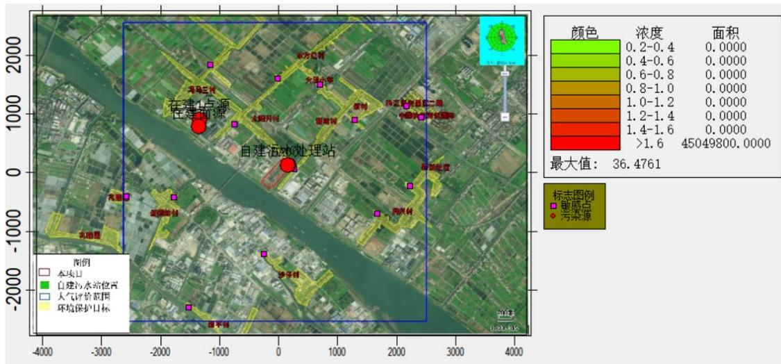
图 5.2-12 叠加后硫化氢 (H<sub>2</sub>S) 小时浓度预测值等值线图 (单位:µg/m<sup>3</sup>)
