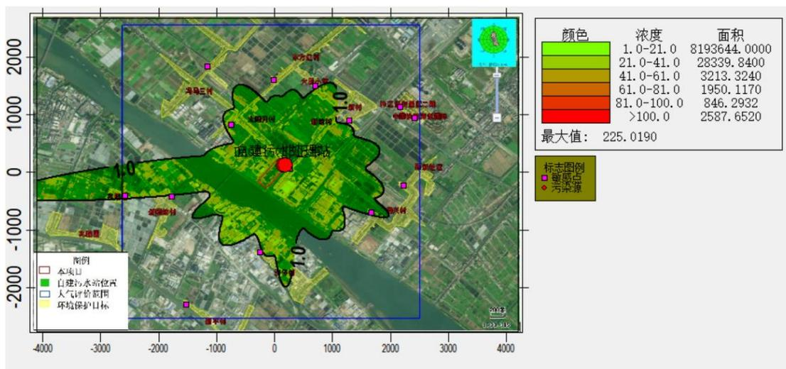
图 5.2-16 非正常工况 NMHC 小时浓度贡献值等值线图 (单位: $\mu\text{g}/\text{m}^3$ )
