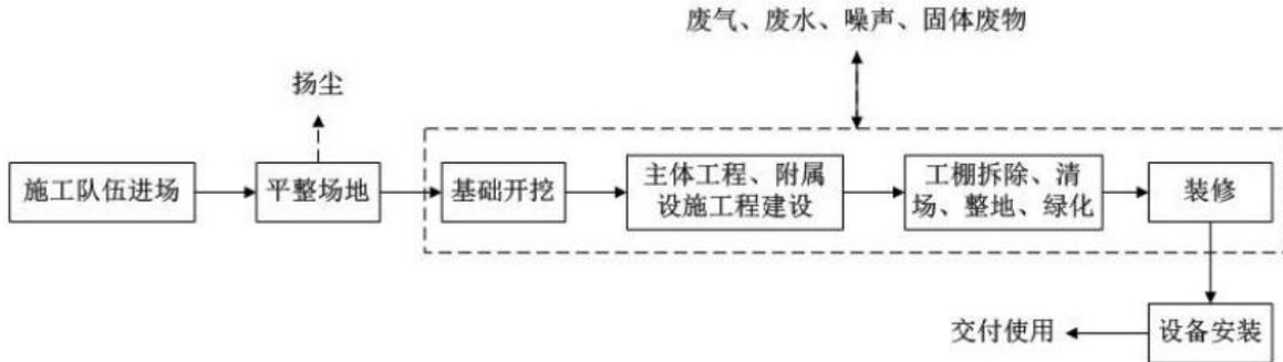
图 3.2-6 施工工艺流程及产污环节示意图
