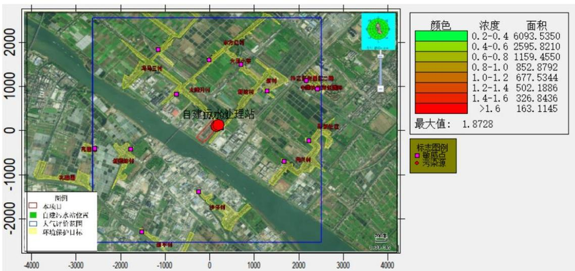
图 5.2-9 硫化氢 (H<sub>2</sub>S) 小时浓度贡献值等值线图 (单位:  $\mu\text{g}/\text{m}^3$ )
