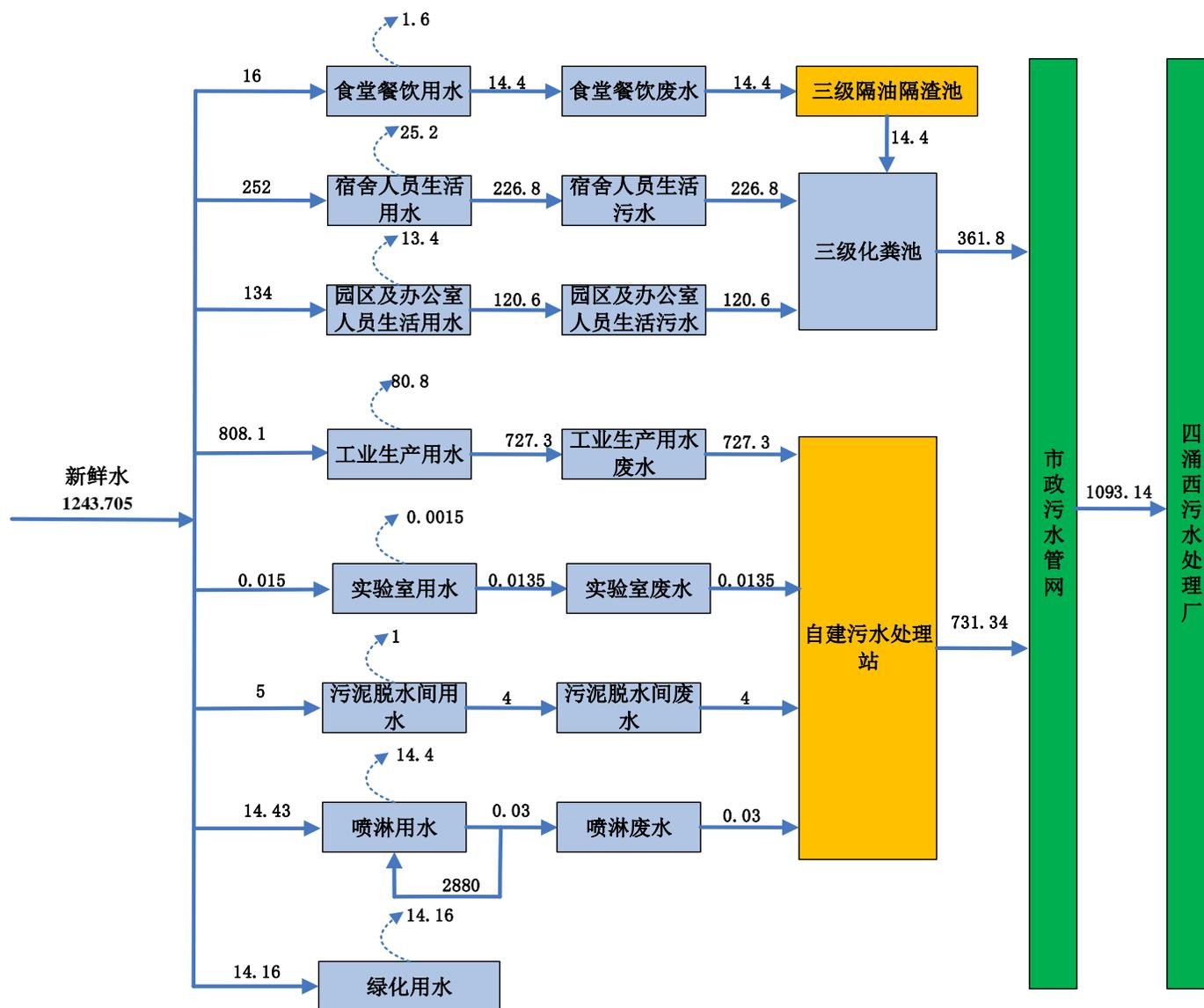
图 3.1-7 本项目水平衡图 单位 (t/d)
