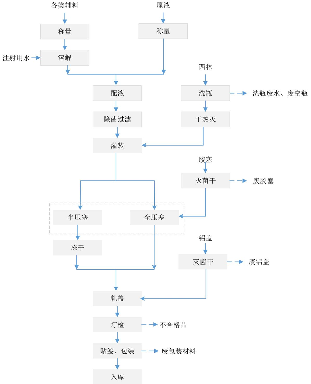
图 3.2-4 新型制剂典型生产工艺
