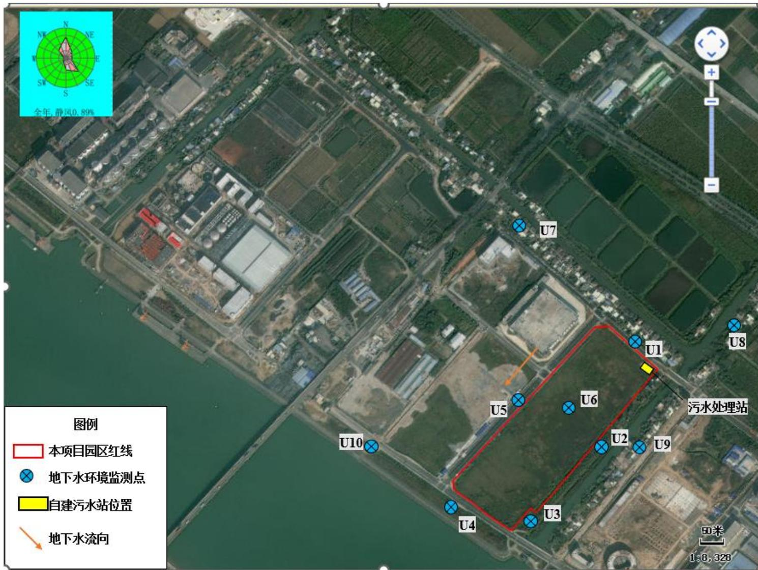
图 4.5-1 (1) 地下水监测布点示意图
