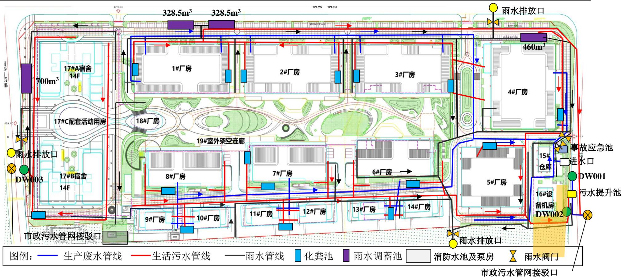
图 3.1-8 本项目雨水污水管网图
