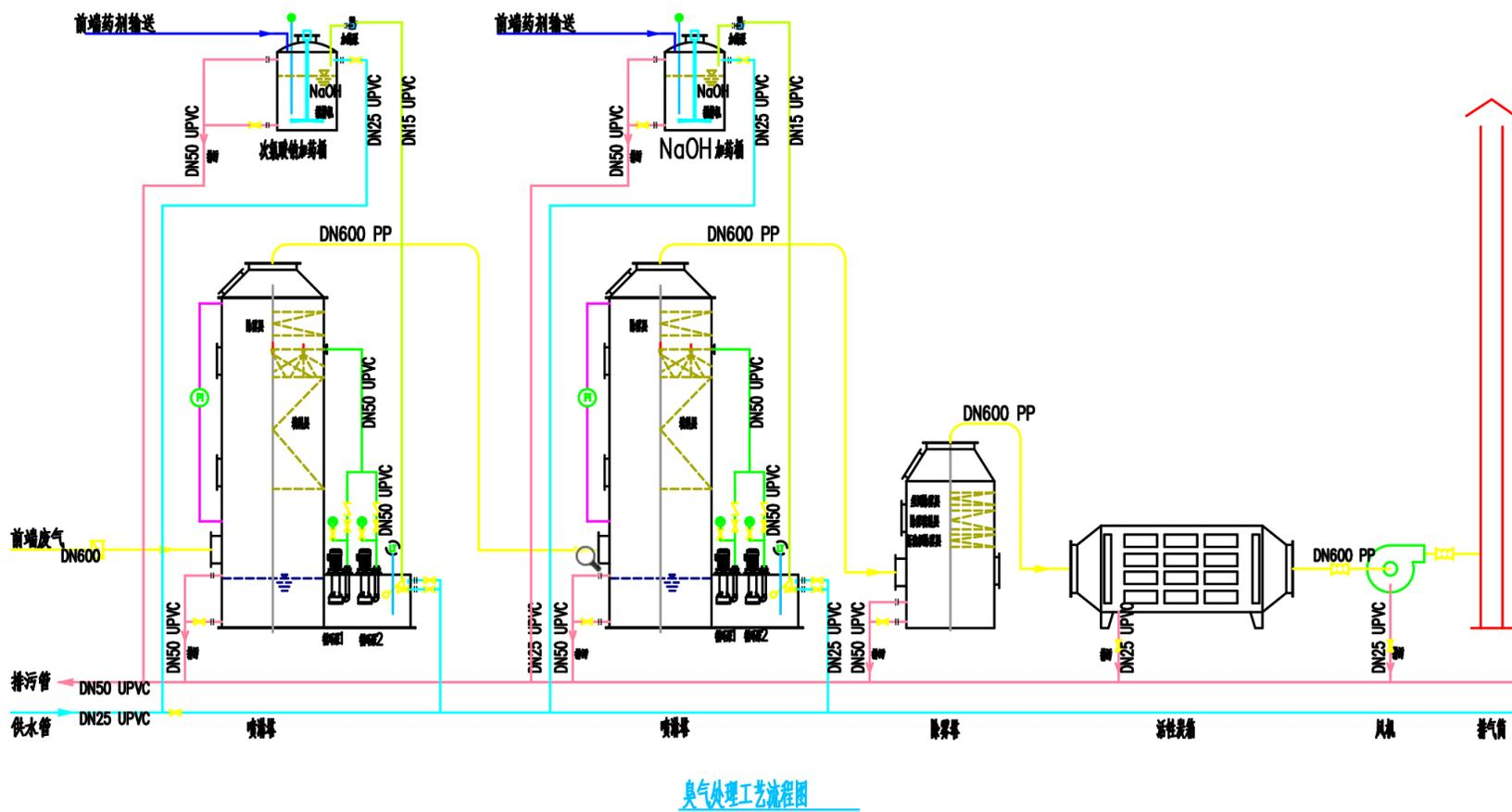
图 6.3-1 废气处理工艺流程图
