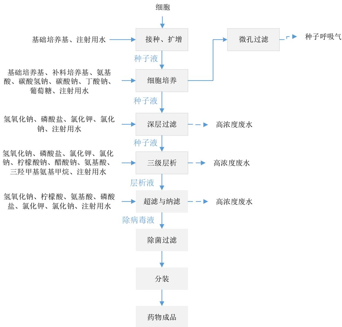
图 3.2-5 生物制药典型生产工艺
