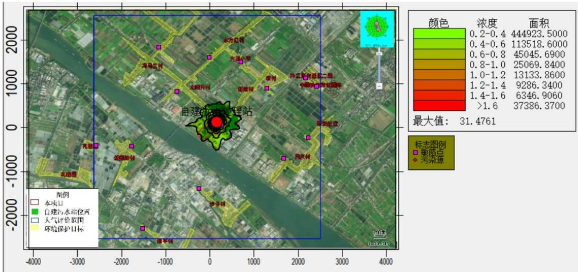
图 5.2-8 氨气 (NH<sub>3</sub>) 小时浓度贡献值等值线图 (单位  $\mu\text{g}/\text{m}^3$ )
