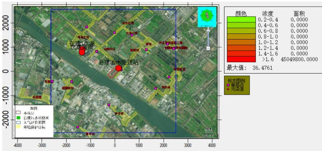
图 5.2-11 叠加后氨气 (NH<sub>3</sub>) 小时浓度预测值等值线图 (单位 µg/m<sup>3</sup>)
