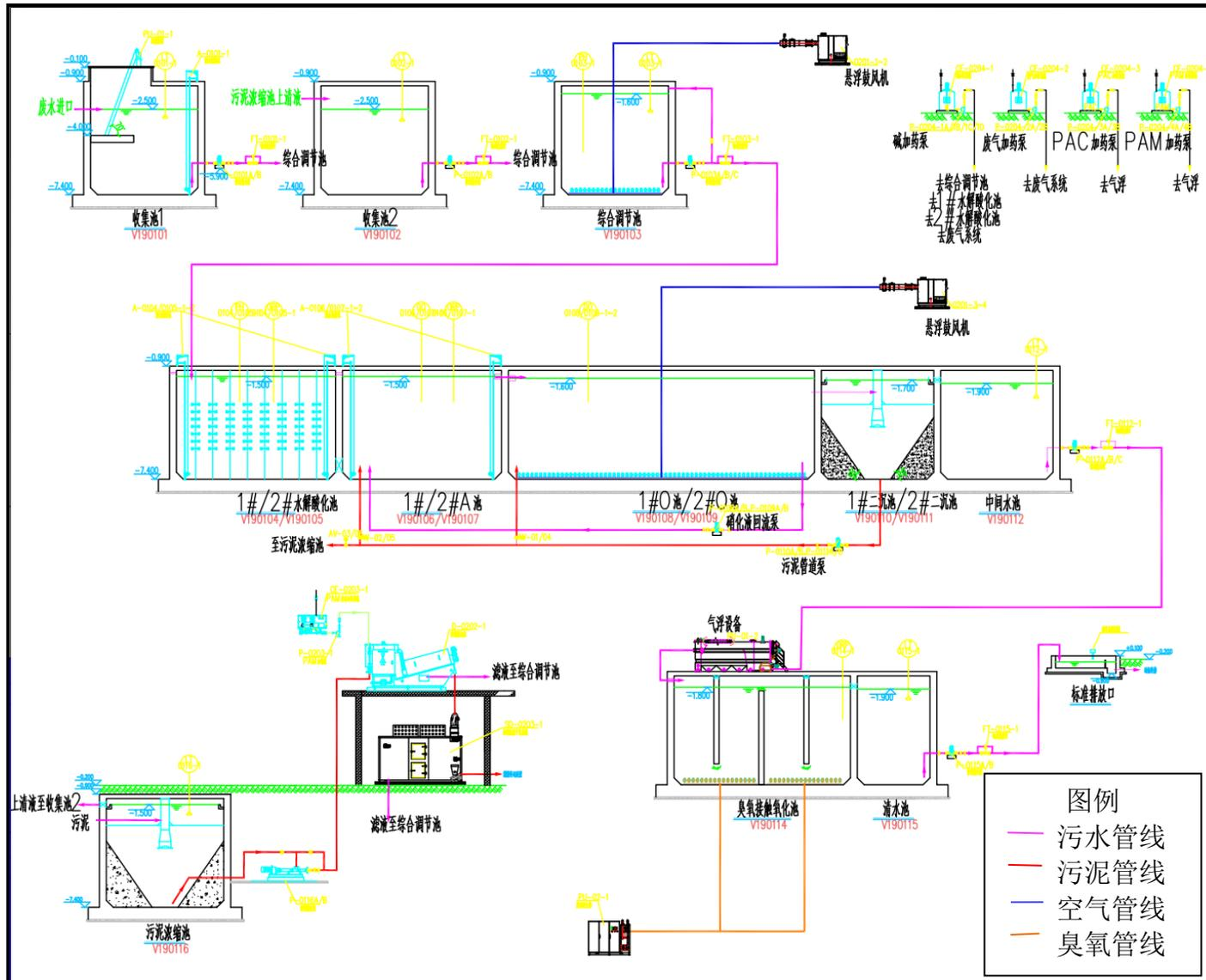
图 3.2-8 污水处理站设备连接图
