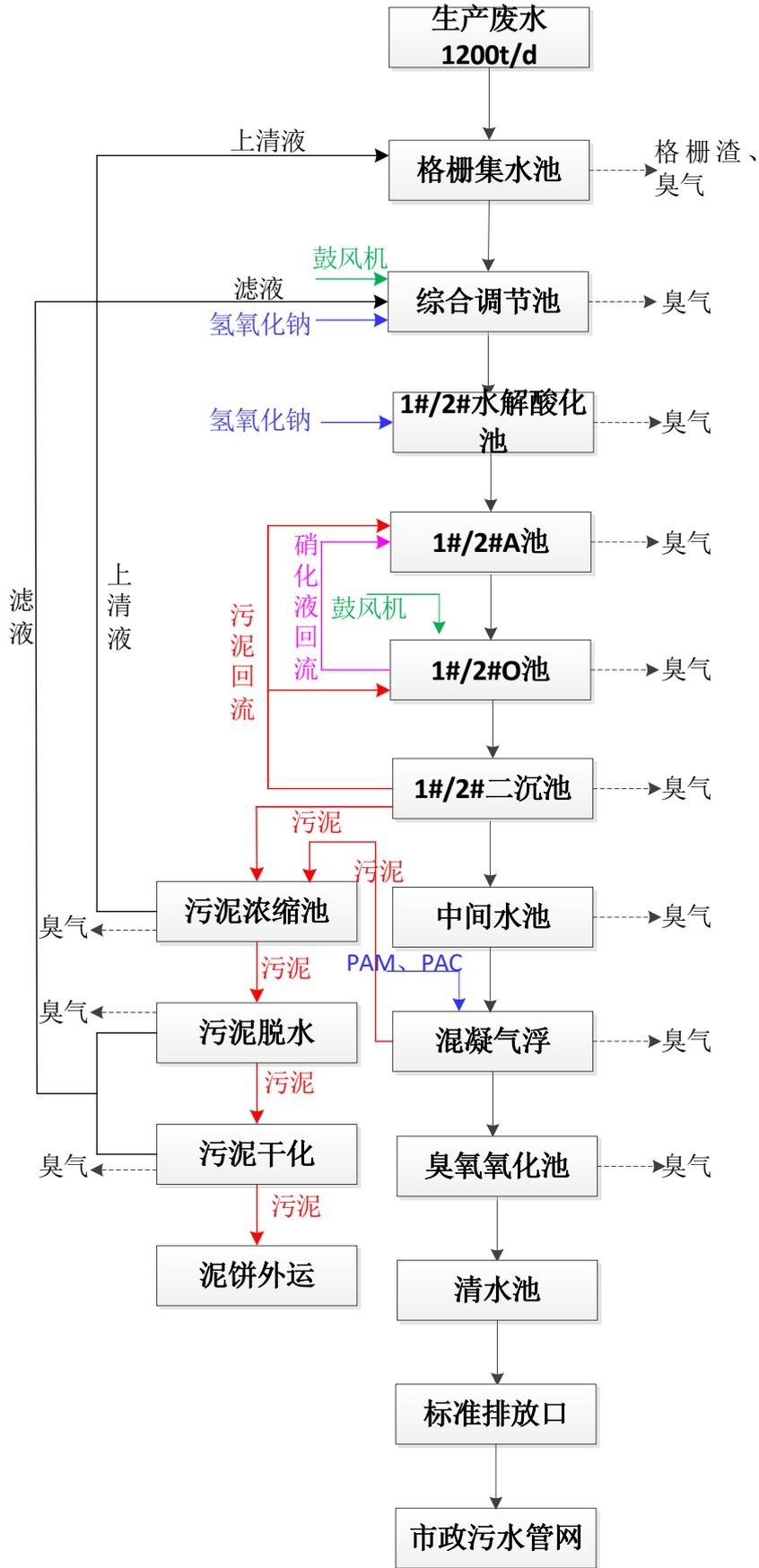
图 3.2-7 废水处理站污水处理工艺流程图
