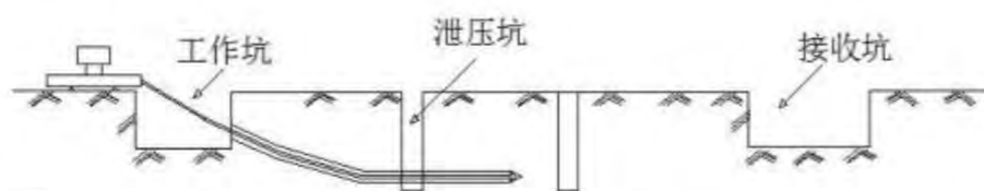
图 2-4 先导孔钻进示意图
