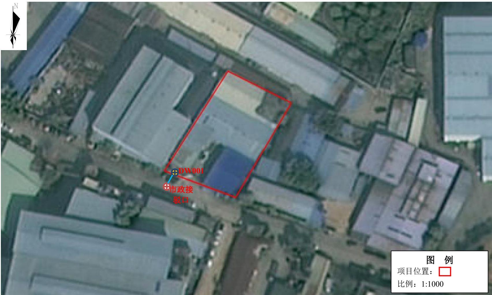
附图 2-2 项目污水口与市政接驳口位置关系图
