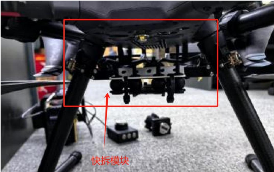
图 9.1-1 快拆模块示意图
