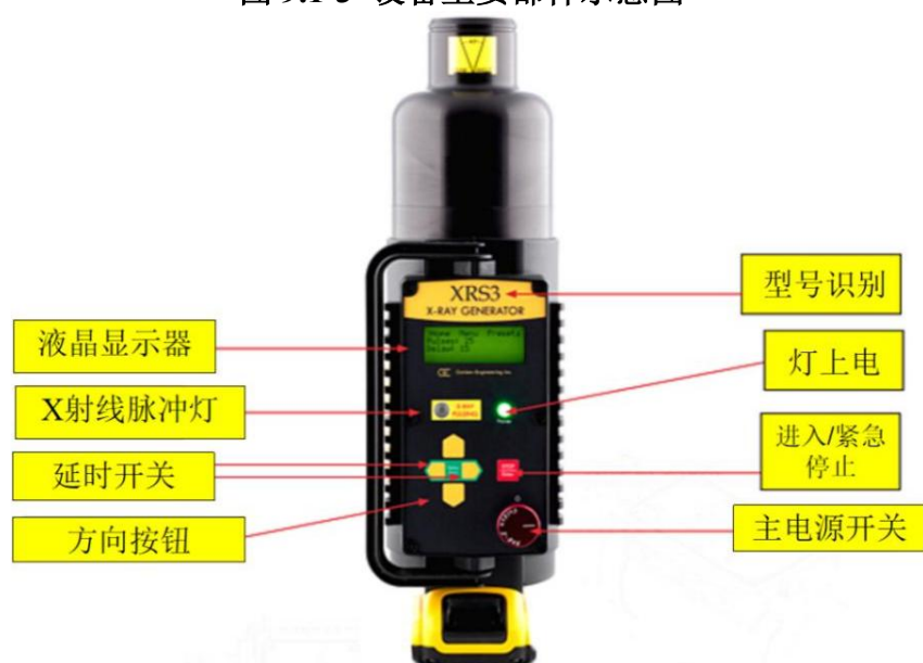
图 9.1-4 XRS3 型脉冲式 X 射线机控制模块示意图
