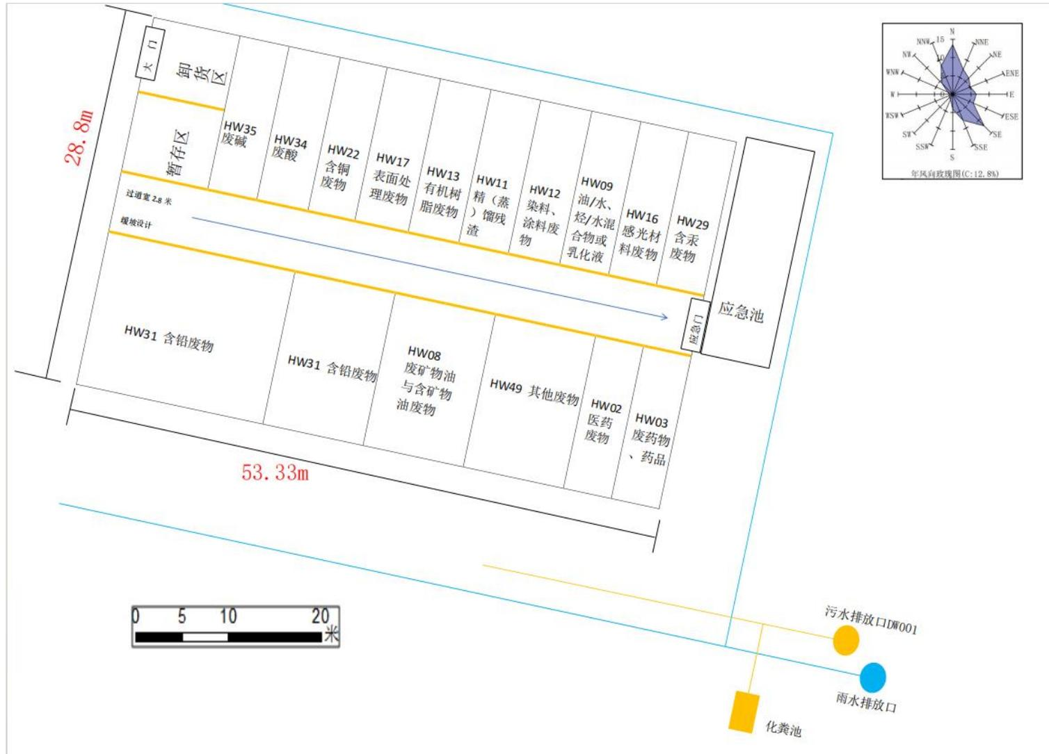
图 7.3-1 项目厂区雨水收集管网图
