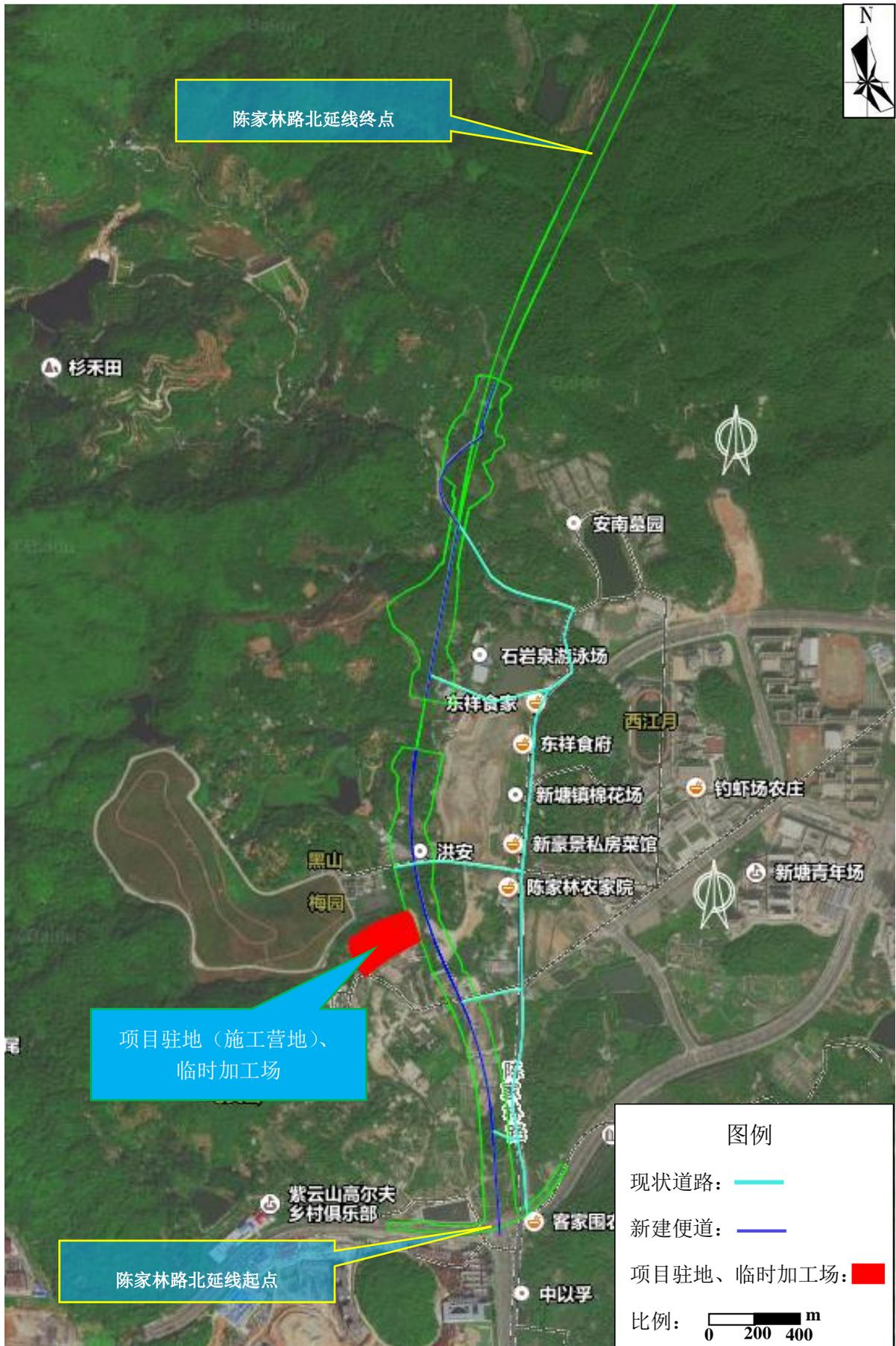
图 3.1-17 本项目驻地 (施工营地)、临时加工场、施工便道布置图
