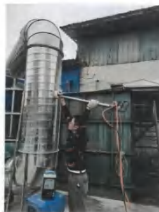
脱模、压铸废气处理前采样口 G2
