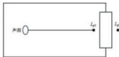
图 4-2 室内声源等效为室外声源图例
