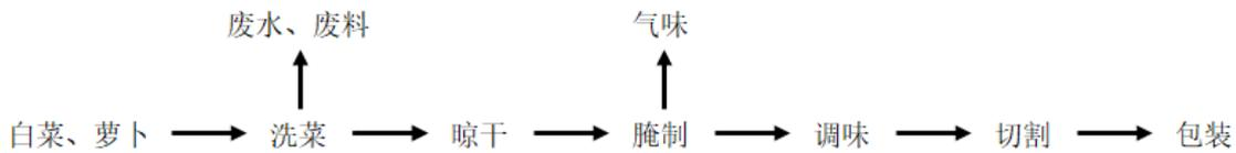
图 2-5 原项目工艺流程图
