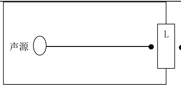
图 4-4 室内声源等效为室外声源图例
