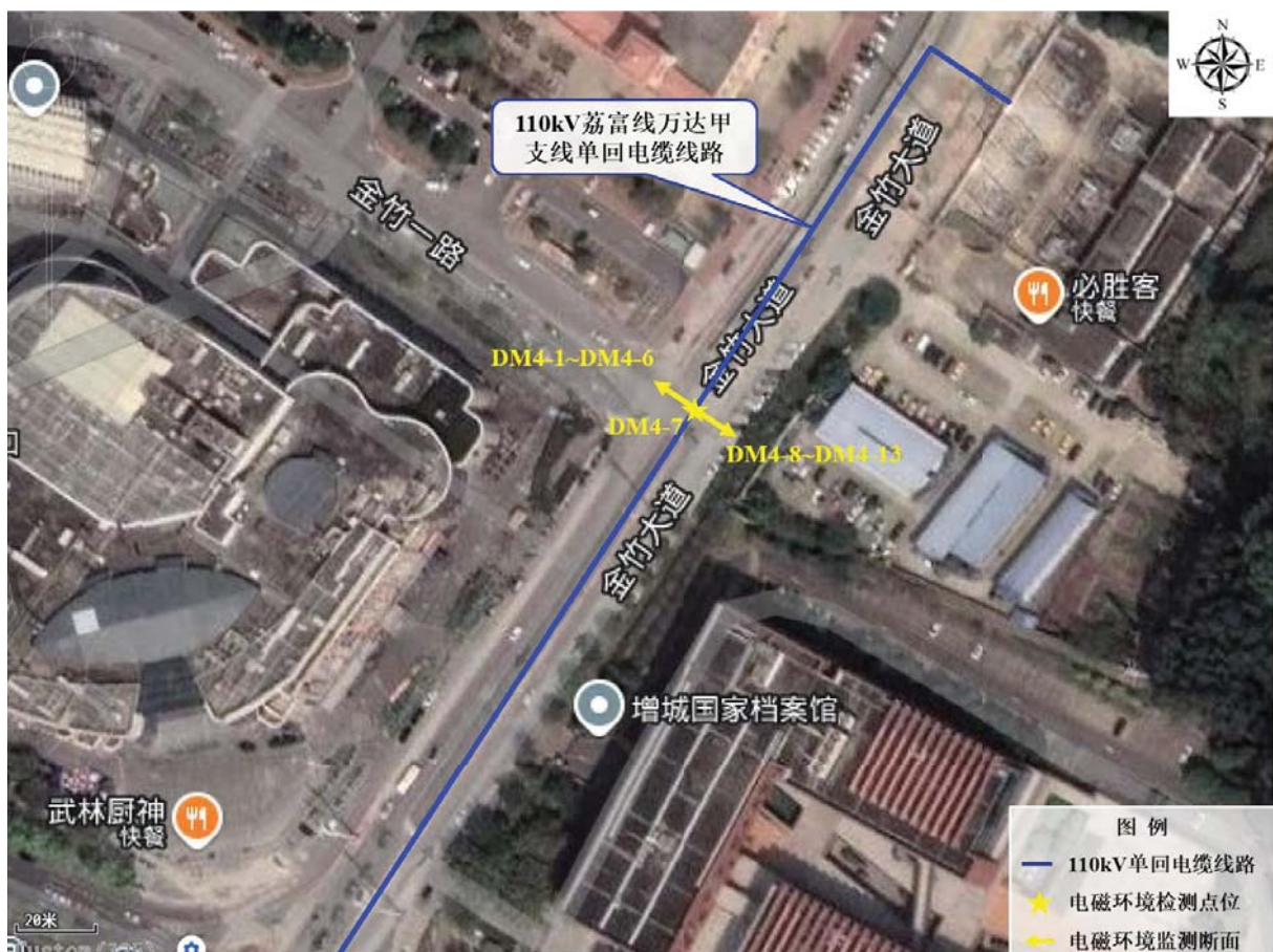
图 1-6 类比电缆线路工频电场和工频磁场监测布点图
