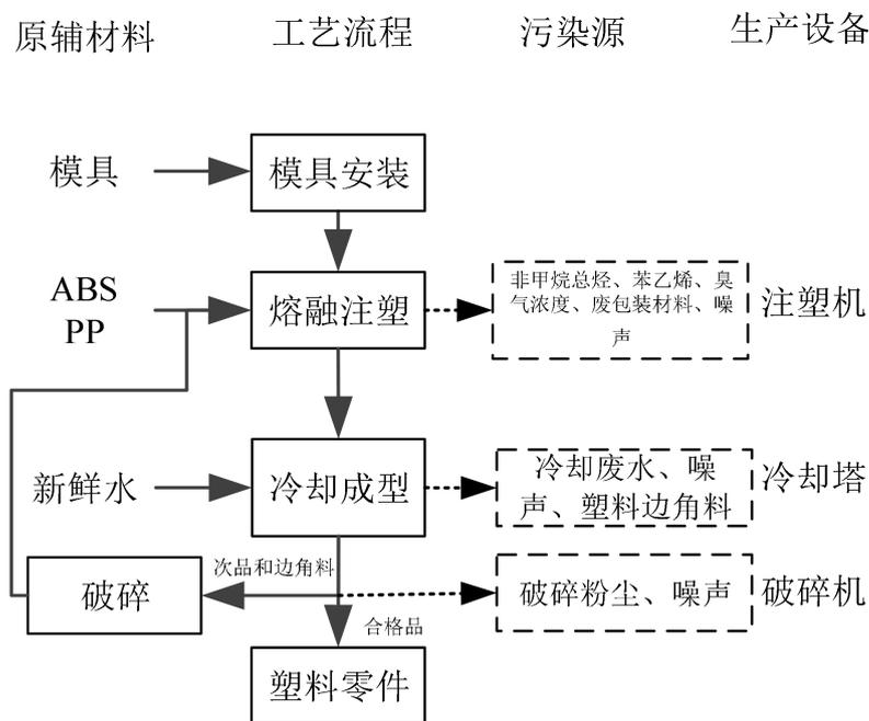
图 2-3 本扩建项目生产水处理过滤器配件的工艺流程图
