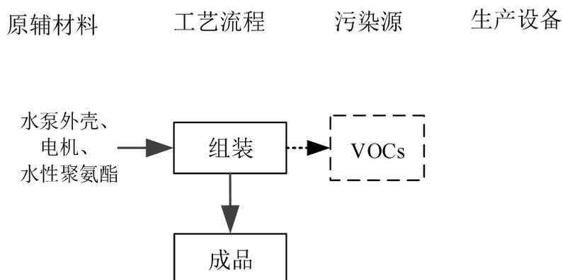
图 2-8 水泵生产工艺流程图
