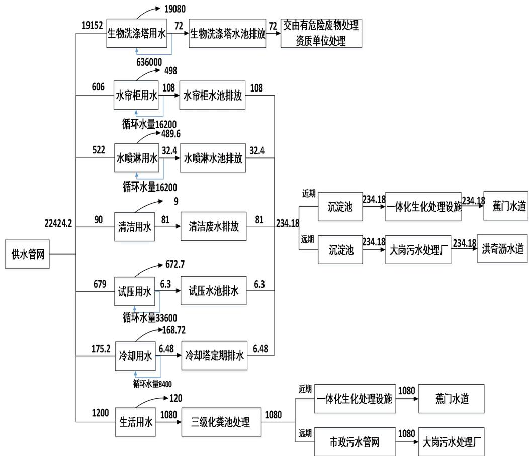
图 2-2 扩建后项目给排水平衡图 (t/a)
