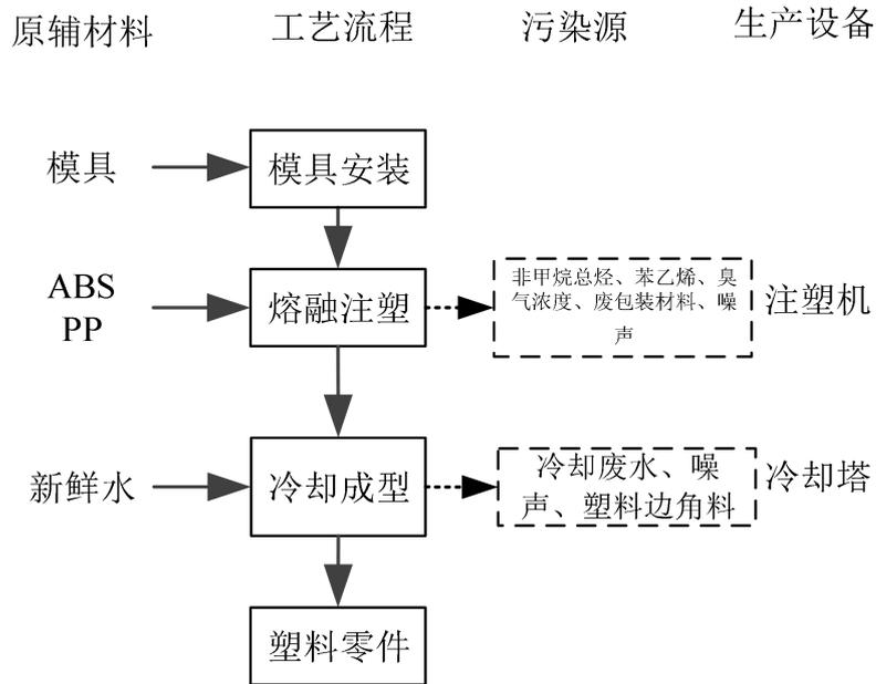
图 2-5 塑料零件生产工艺流程图
