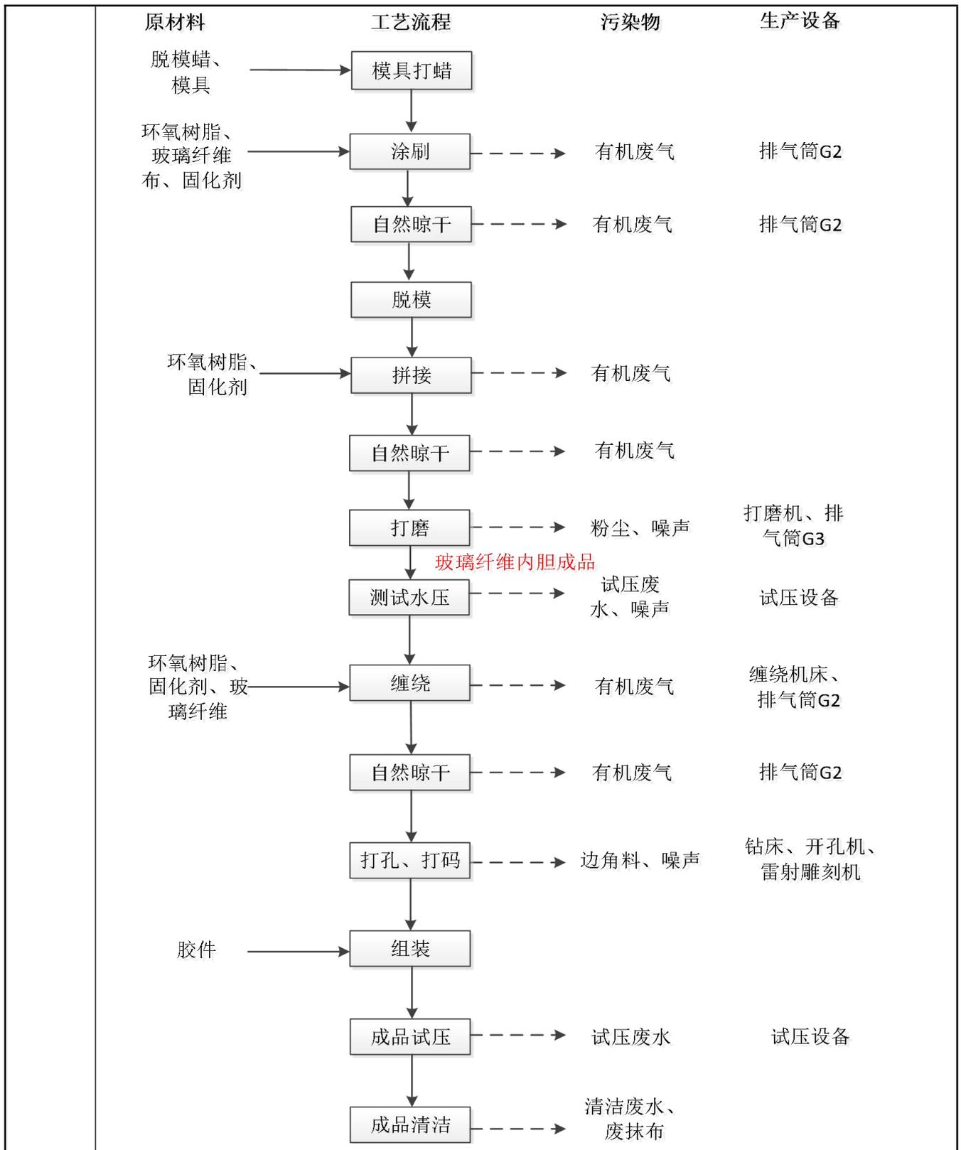
图 2-6 水处理过滤器生产工艺流程图
