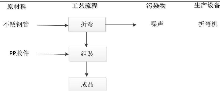
图 2-7 不锈钢扶梯生产工艺流程图
