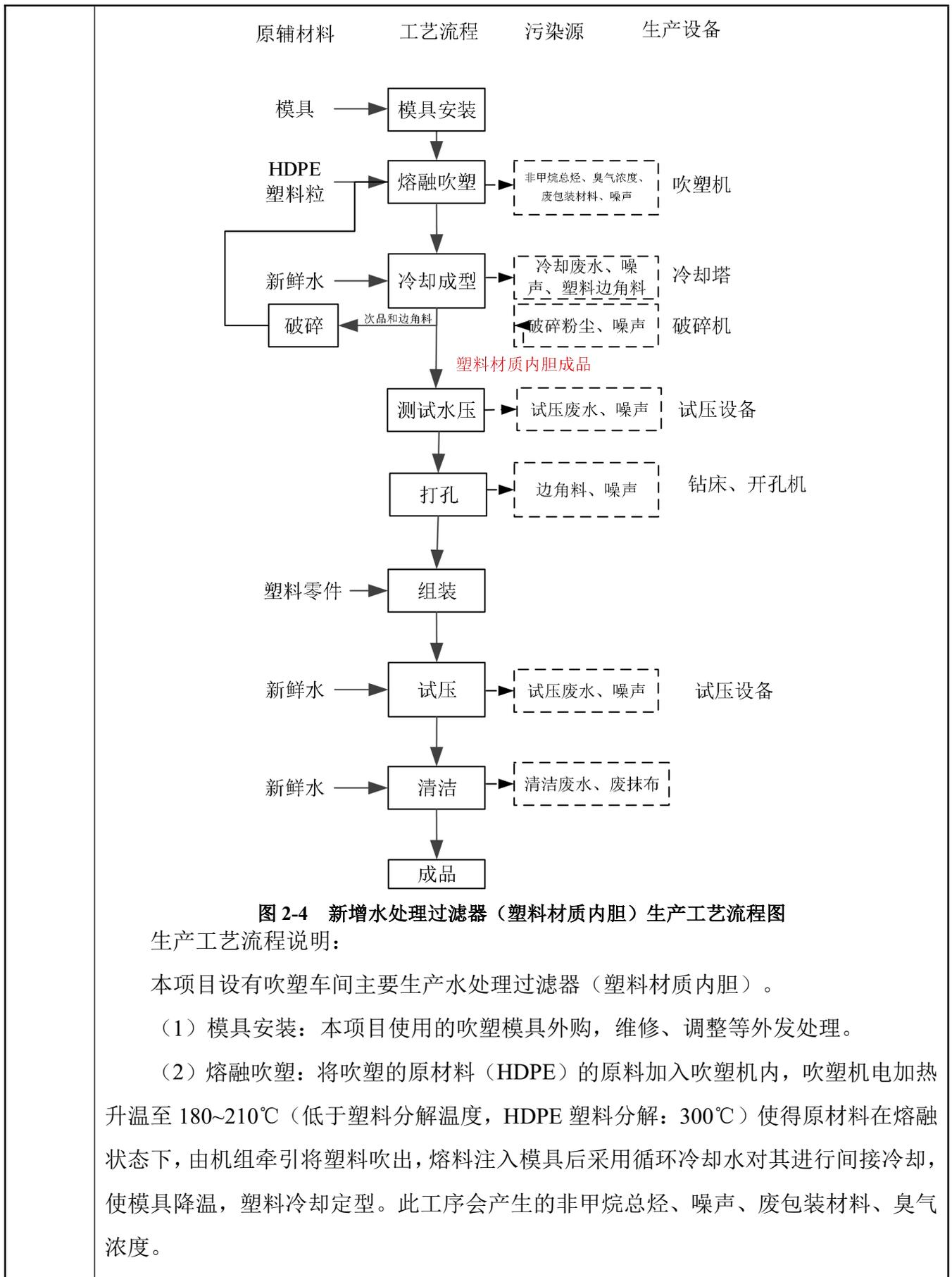
(3) 冷却成形：塑料挤出后，在模具的作用下，确定好性状规格。在吹塑机内部的冷却系统下，塑料通过冷却定型。此工序会产生冷却废水和噪声、塑料边角料。
