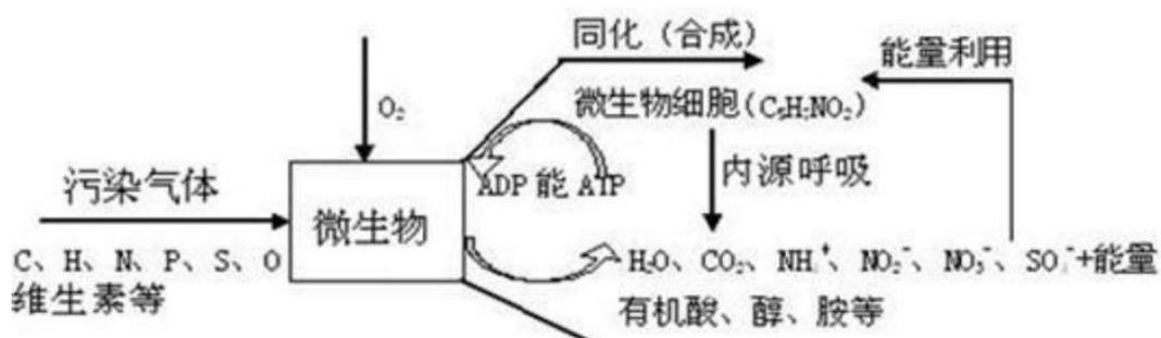
图 4-3 生物洗涤塔处理原理
