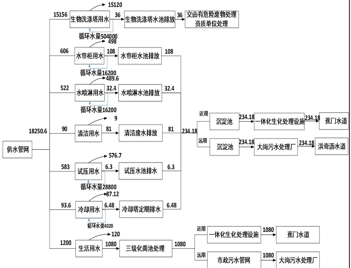
图 2-1 原有项目水平衡图
