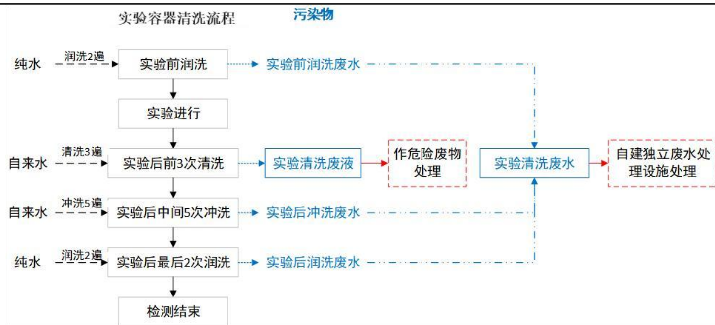
图 7 本项目实验室容器用水流程图
