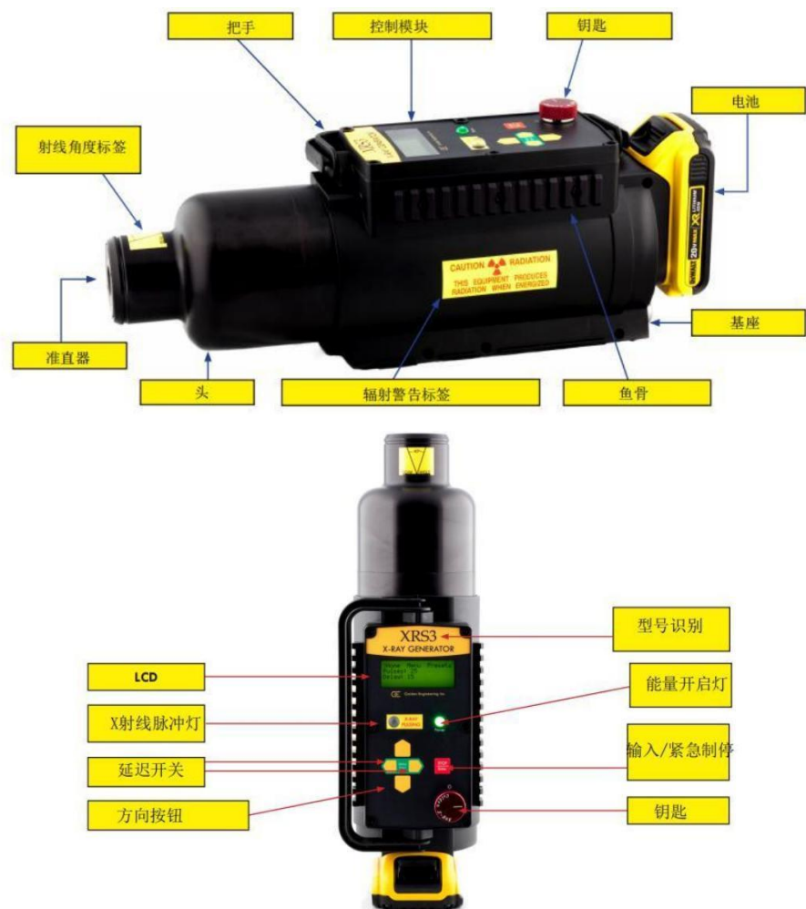
图 10-1 XRS3 型 X 射线探伤装置辐射安全设施分布图
