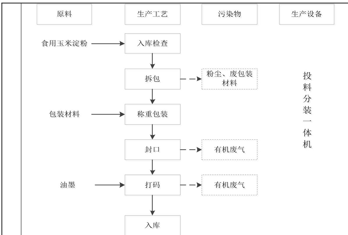
图 2-2 淀粉分装生产工艺流程图
