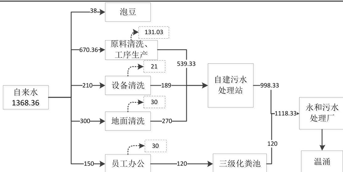
图 2-1 项目水平衡图 (单位:  $\text{m}^3/\text{a}$ )
