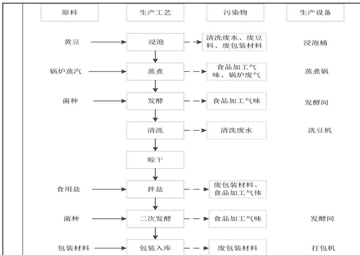
图 2-3 豆豉生产工艺流程图
