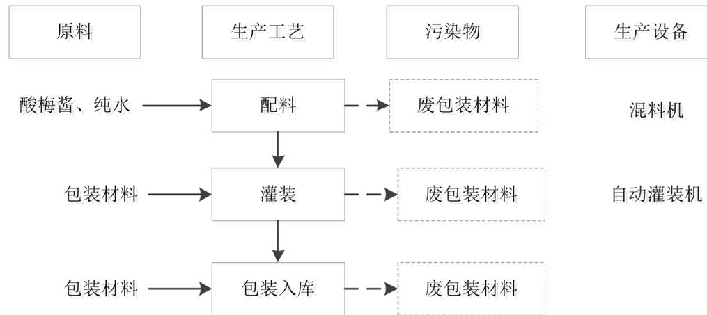
图 2-5 酸梅酱生产工艺流程图
