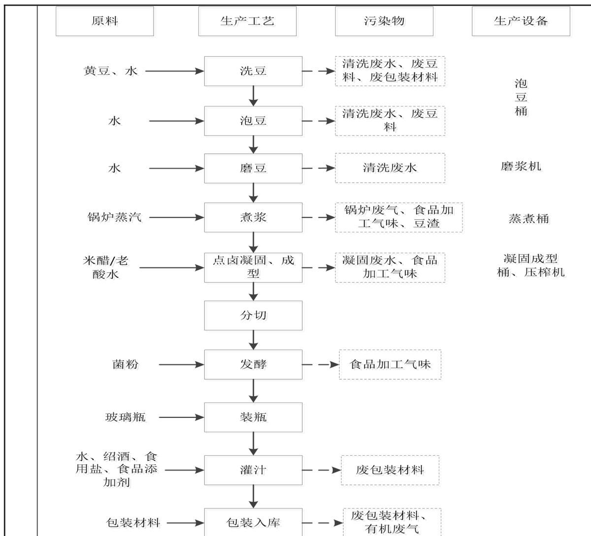
图 2-4 腐乳生产工艺流程图
