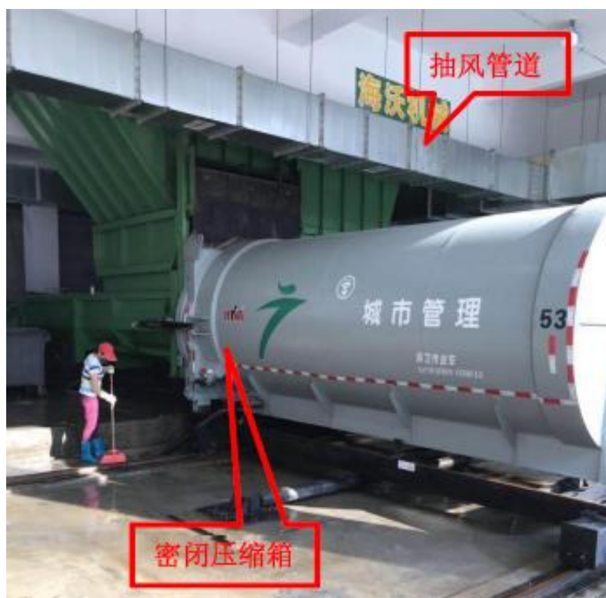
图 4-6 密闭压缩箱参照图
