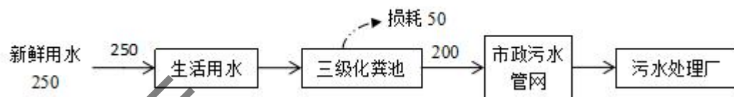
图 2-2 本项目水平衡图 (t/a)
