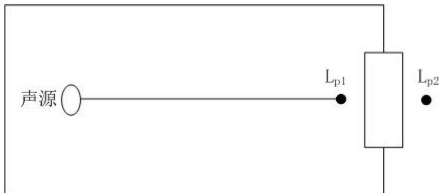
图 4-2 室内声源等效为室外声源图例
