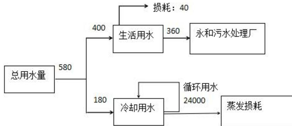
图4-1 本项目水平衡图（单位：t/a）
