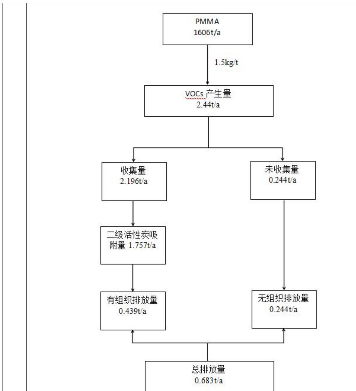
图 2-1 项目 VOCs 平衡图
