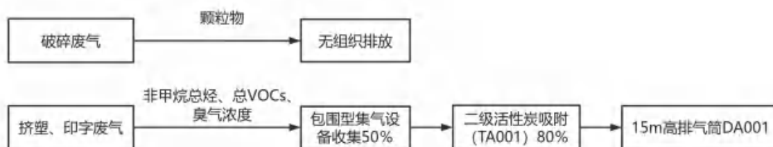
图 4-1 项目废气收集及治理流程图
