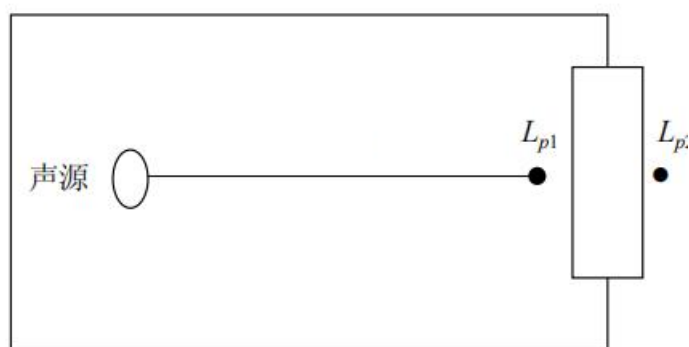
图 4-2 室内声源等效为室外声源图例
