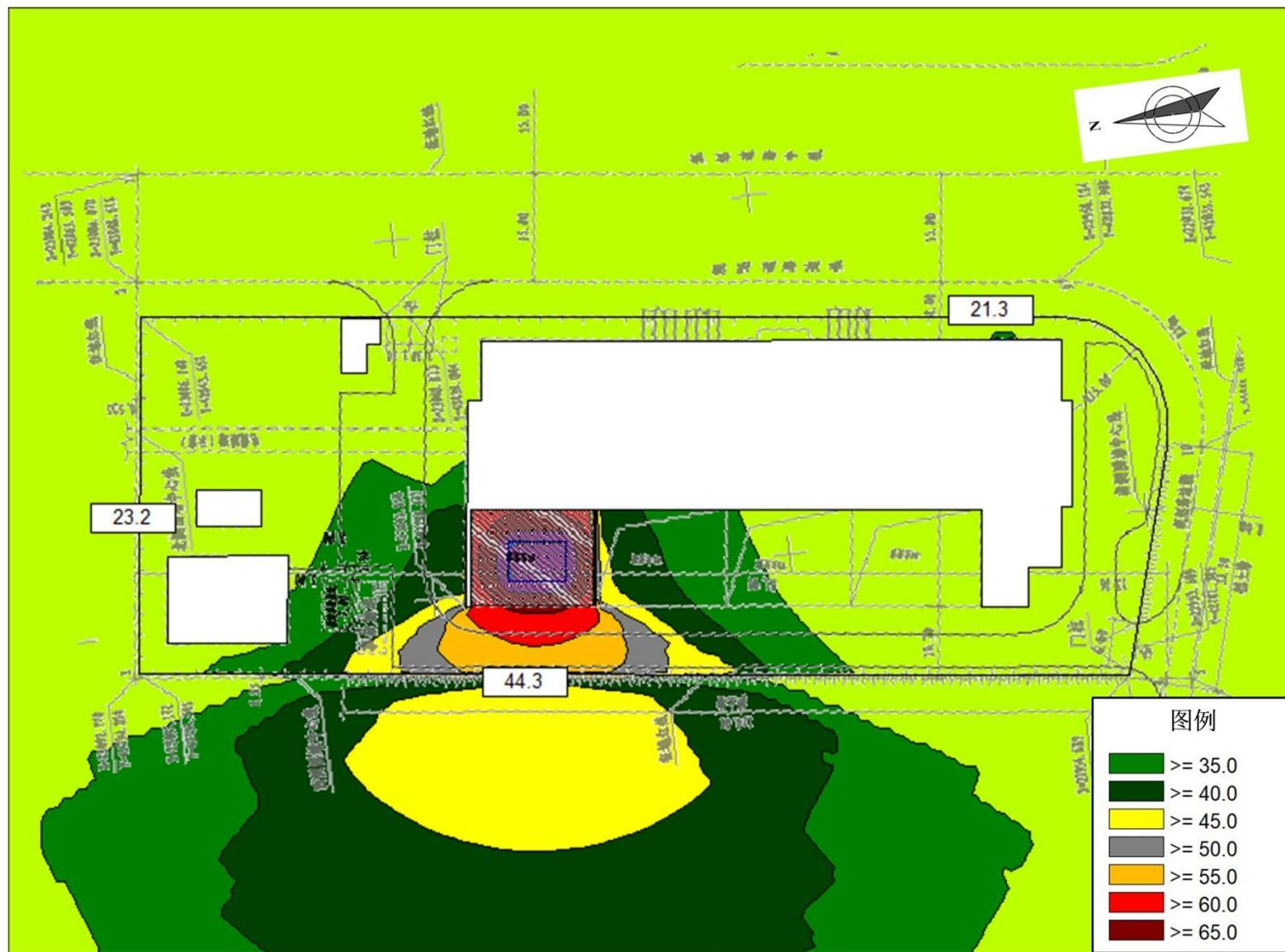
图 4-8 220kV 厚德变电站本期建成运行噪声贡献值等声级线图 (预测点高度为地面上方 1.2m)
