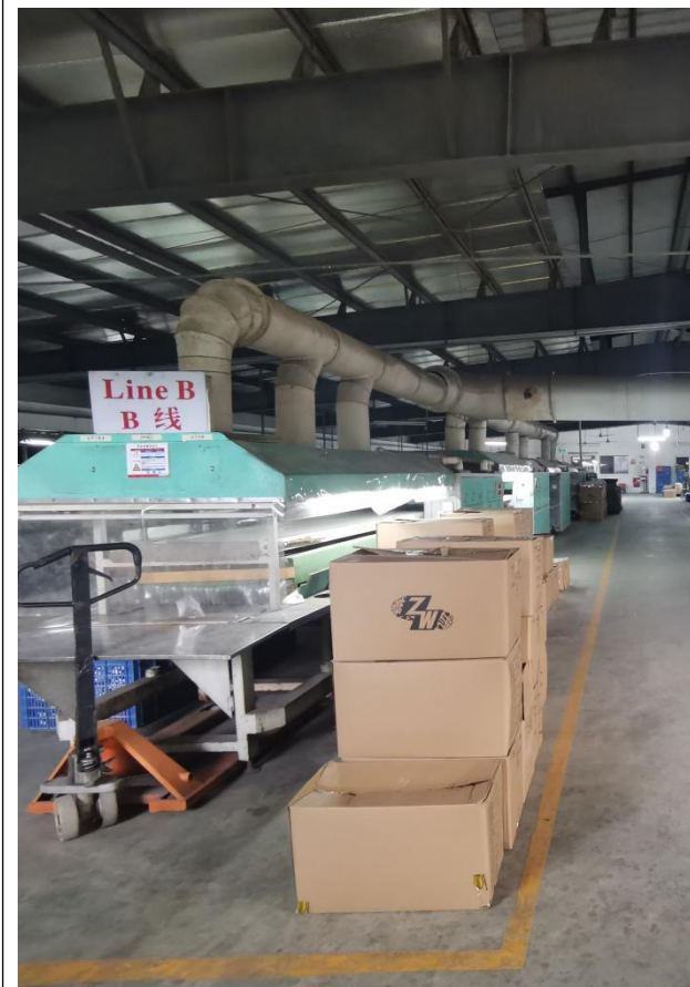
EVA 橡胶复合鞋底：贴合线（刷胶、贴合、烘干）
