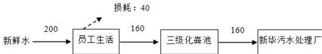
图2-1 本项目水平衡图
