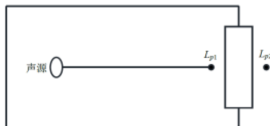
图 4-2 室内声源等效为室外声源图例
