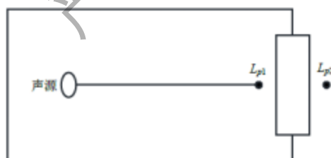
图4-2 室内声源等效为室外声源图例
