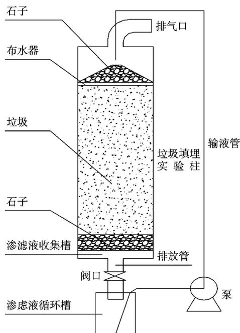
图 1 渗滤液回灌实验装置示意
