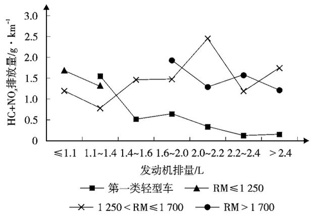
图 6 各排量车辆 HC+NO<sub>x</sub> 排放均值
