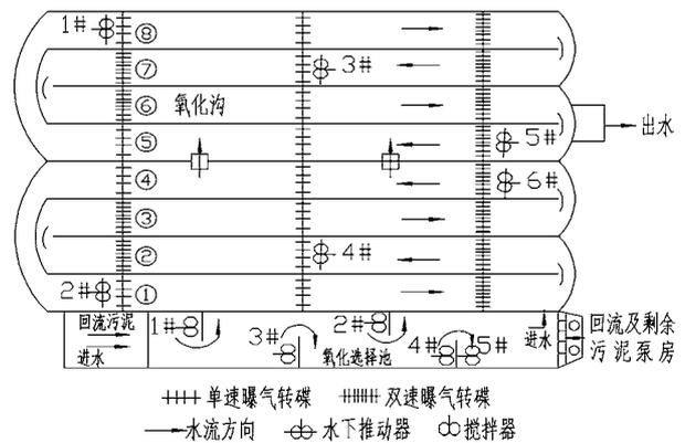
图 1 改良氧化沟单组沟平面示意
