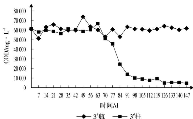
图 6 3<sup>#</sup>瓶和 3<sup>#</sup>柱渗滤液的降解曲线
