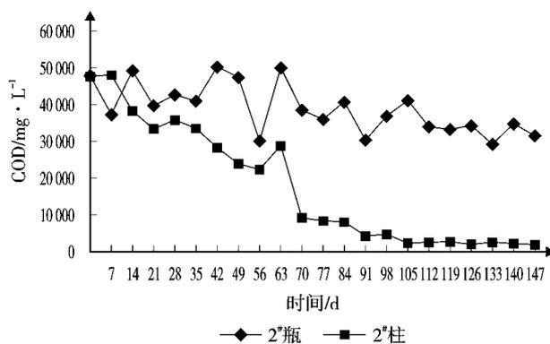
图 5 2<sup>#</sup>瓶和 2<sup>#</sup>柱渗滤液的降解曲线
