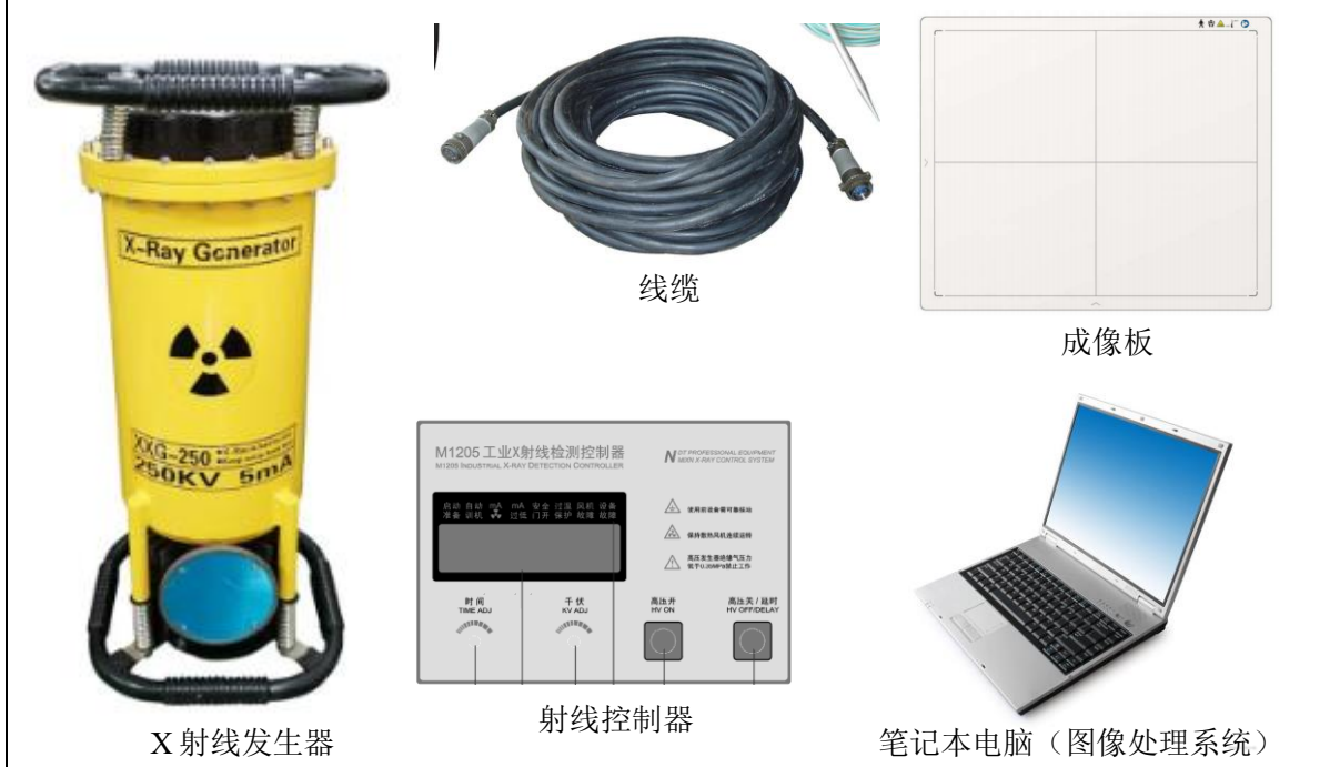
图 9-1 XXG-2505X 型 X 射线探伤装置设备组成
