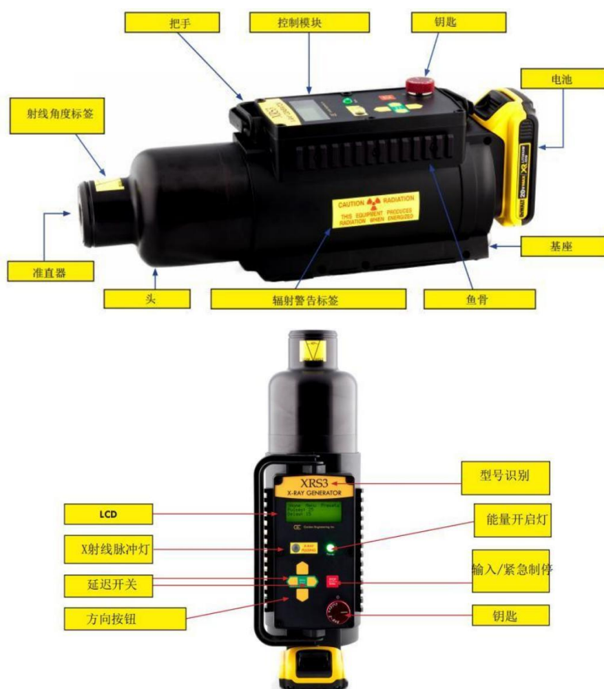
图 10-1 XRS3 型 X 射线探伤装置辐射安全设施分布图
