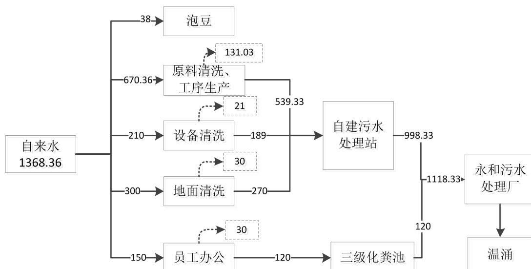
图 2-1 项目水平衡图（单位：m<sup>3</sup>/a）
