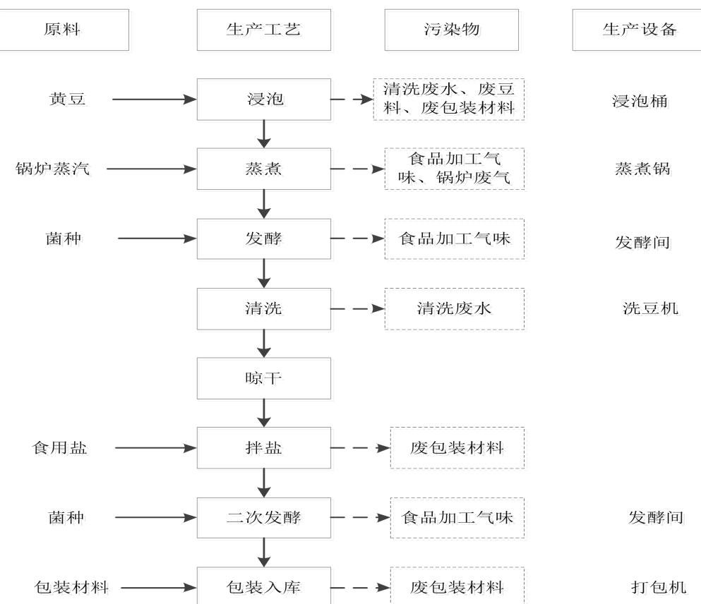
图 2-3 豆豉生产工艺流程图
