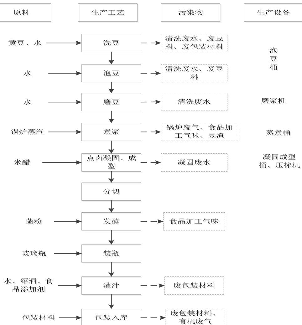
图 2-4 腐乳生产工艺流程图
